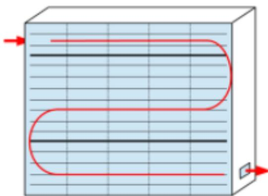
**Slika 30. Smjer strujanja rashladne tekućine u hladnjaku**
