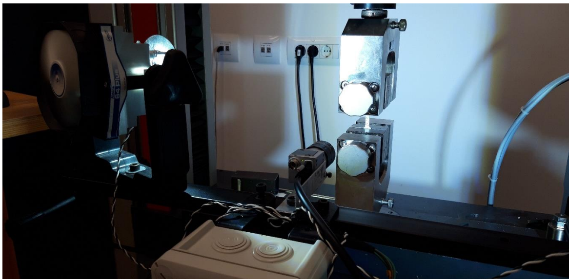
Slika 16. Ispitna konfiguracija za statički vlačni test
