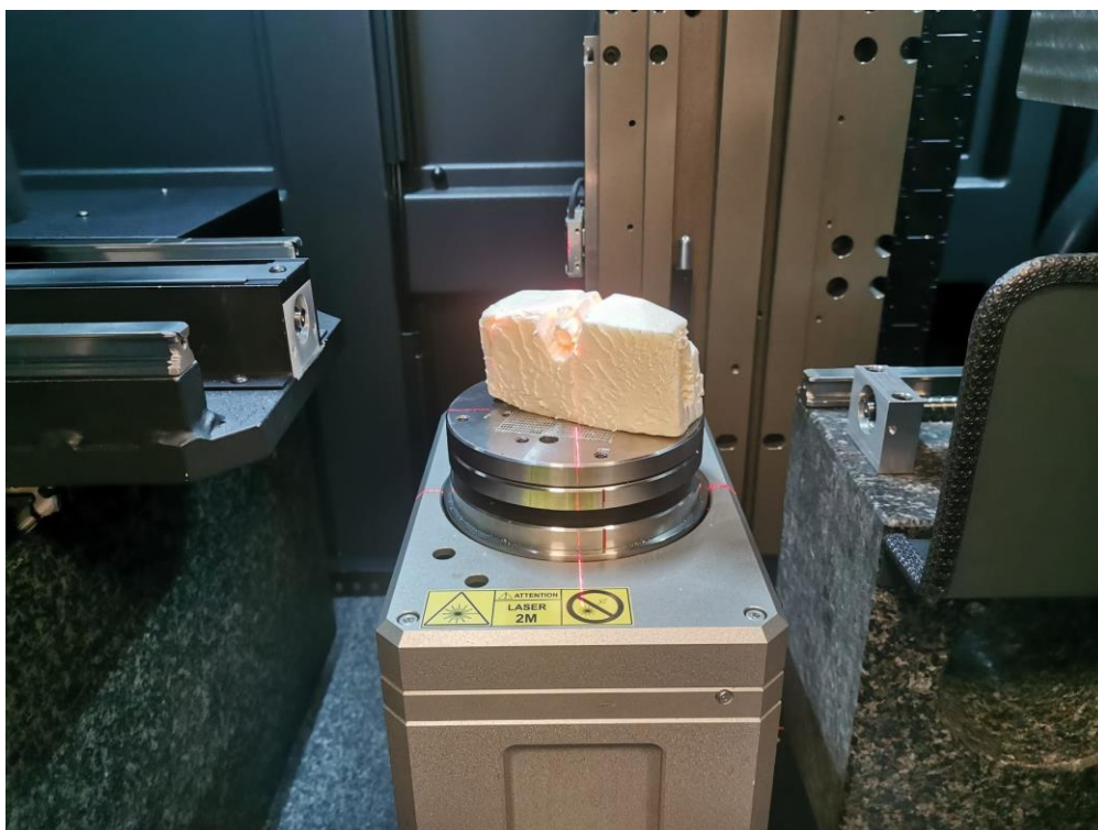
Slika 8. Prikaz pozicioniranog kućišta električnog konektora u CT uređaju
