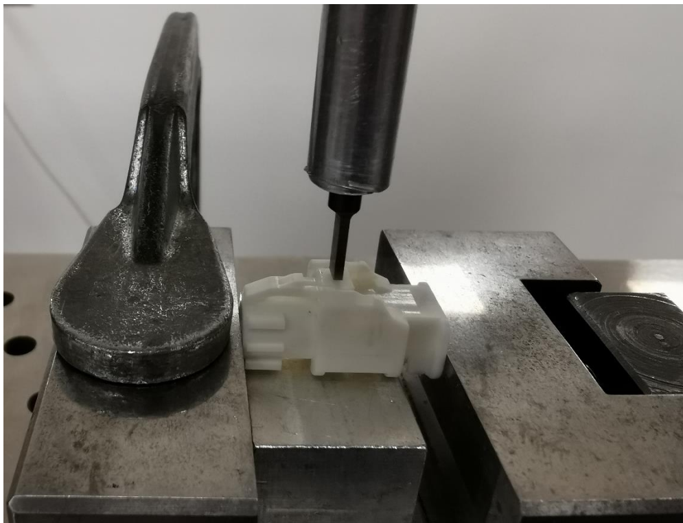
Slika 43. Ispitivanje ponašanja kopče za zaključavanje
