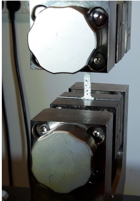
Slika 17. Provođenje statičkog vlačnog ispitivanja materijala Pocan B3225 [11]
