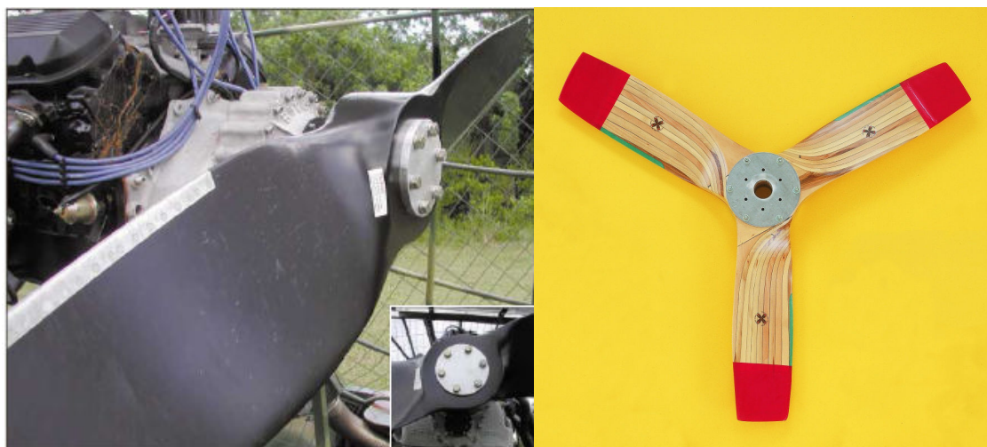
Slike 8 i 9 – Dvokraki kompozitni i trokraki drveni propeler
