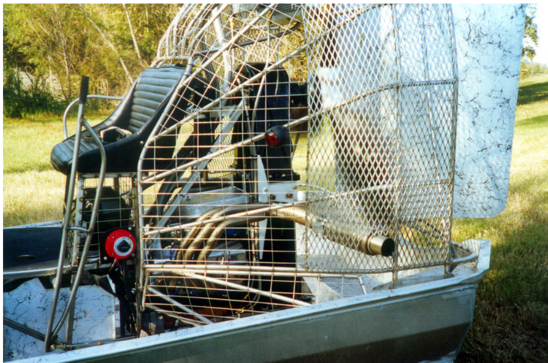
Slika 6 – Smještaj motora nisko u trupu zbog stabilnosti
