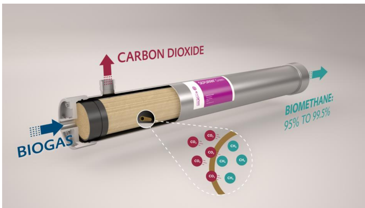
Slika 38. Membranska tehnologija poboljšanja bioplina [37]
