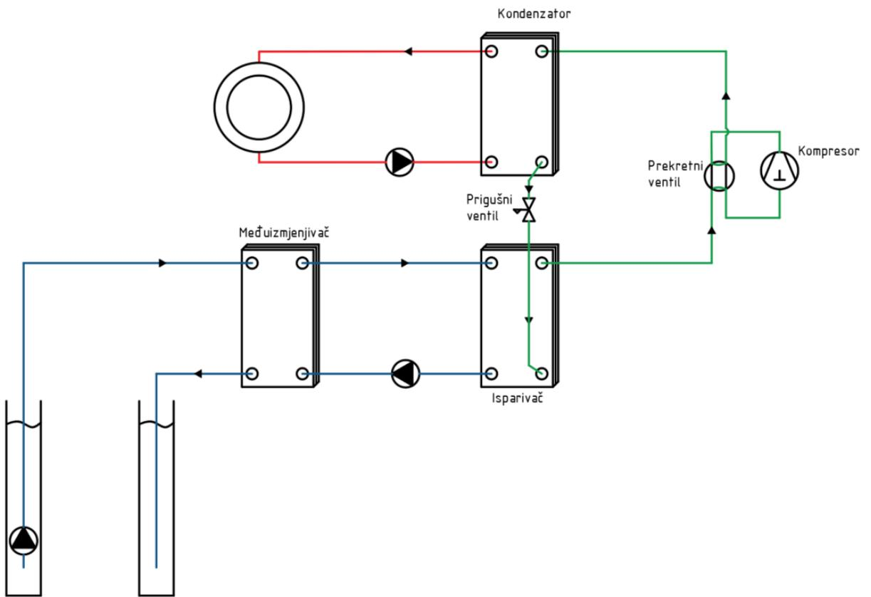
Slika 1. Shematski prikaz kompresijske dizalice topline
