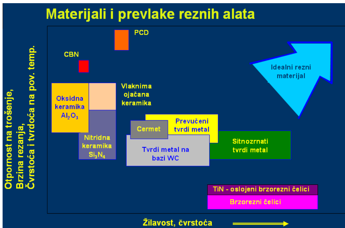
Slika 4. Materijali i prevlake reznih alata [11]
