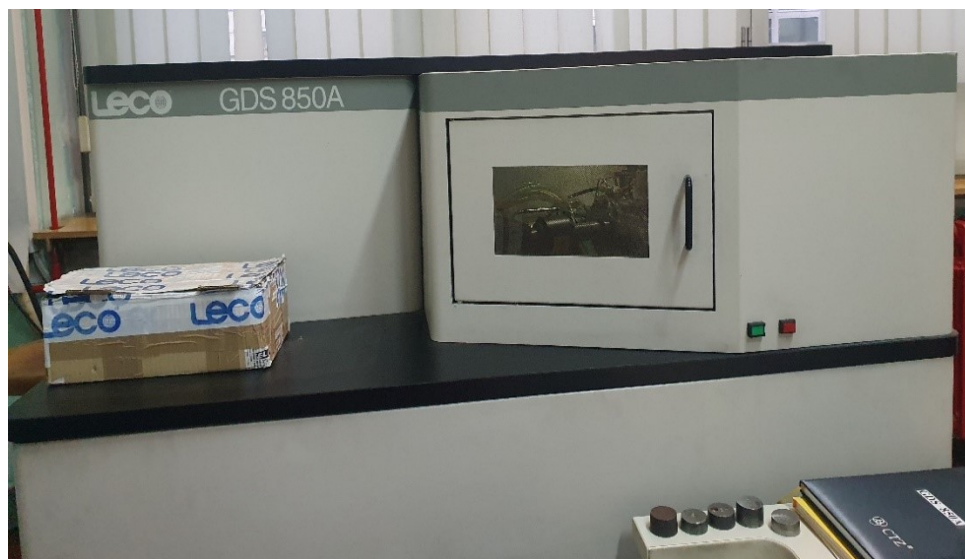
Slika 15. Uređaj za kemijsku analizu GDS 850A, LECO
