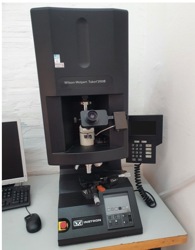
Slika 19. Uređaj za mjerenje mikrotvrdoće Instron Wilson-Wolpert Tukon 2100B
