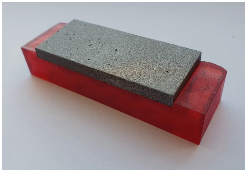
Slika 26. Položaj ispitnog uzorka u držaču
