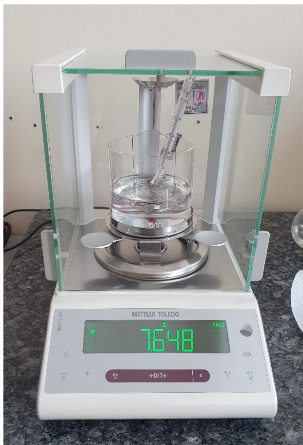
Slika 21. Laboratorijska vaga za mjerenje gustoće Mettler Toledo
