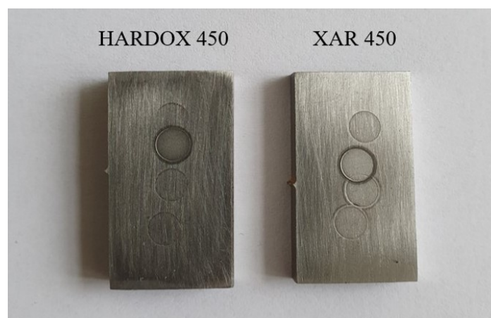
Slika 17. Uzorci čelika Hardox 450 i XAR 450 nakon kemijske analize
