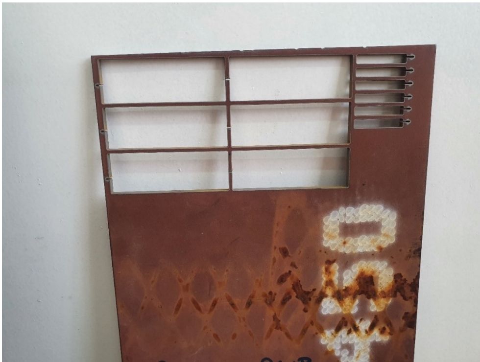
Slika 13. Mjesto izrezivanja uzoraka čelika Hardox 450
