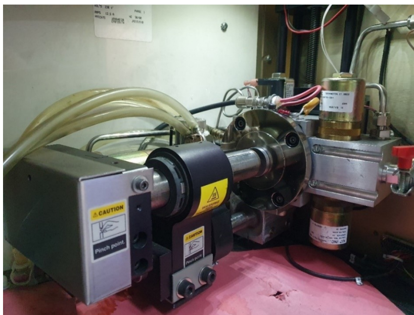
Slika 16. Komora za kemijsku analizu uređaja GDS 850A, LECO
