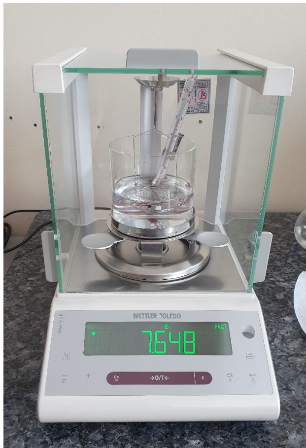
Slika 21. Laboratorijska vaga za mjerenje gustoće Mettler Toledo
