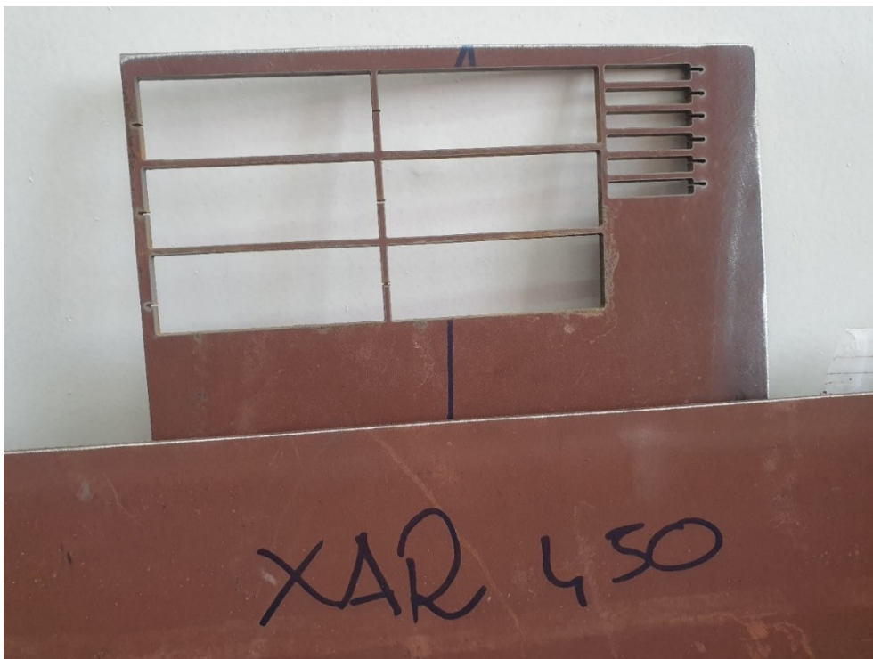
Slika 14. Mjesto izrezivanja uzoraka čelika XAR 450
