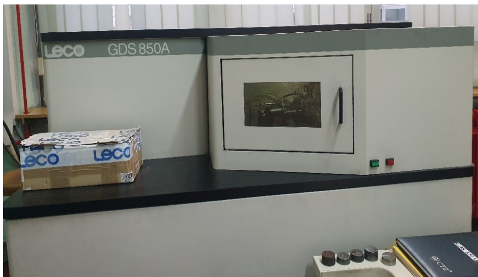
Slika 15. Uređaj za kemijsku analizu GDS 850A, LECO
