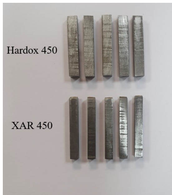
Slika 33. Uzorci za ispitivanje otpornosti na abrazijsko trošenje na uređaju Taber abrader nakon brušenja površine
