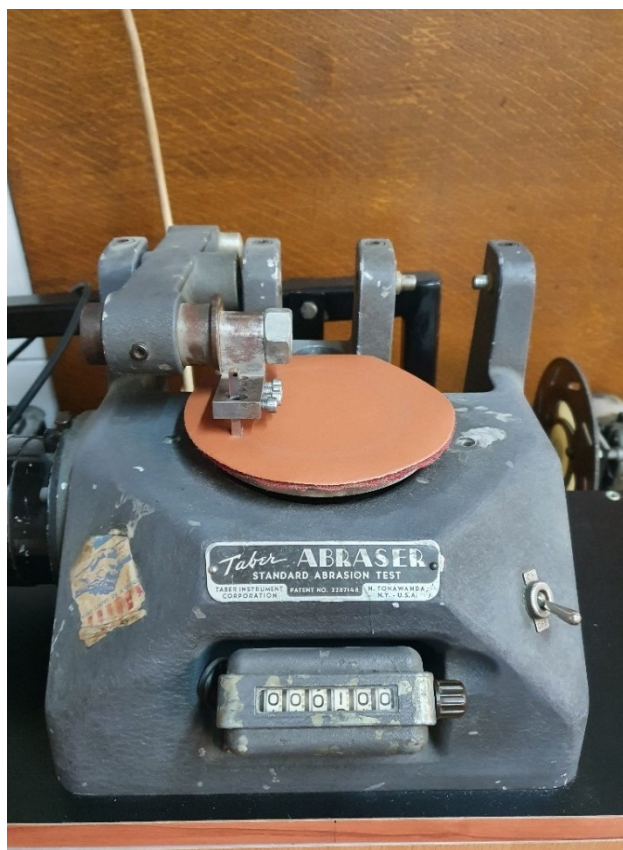
Slika 34. Uređaj Taber abrader
