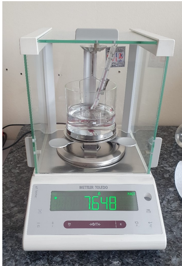
Slika 21. Laboratorijska vaga za mjerenje gustoće Mettler Toledo
