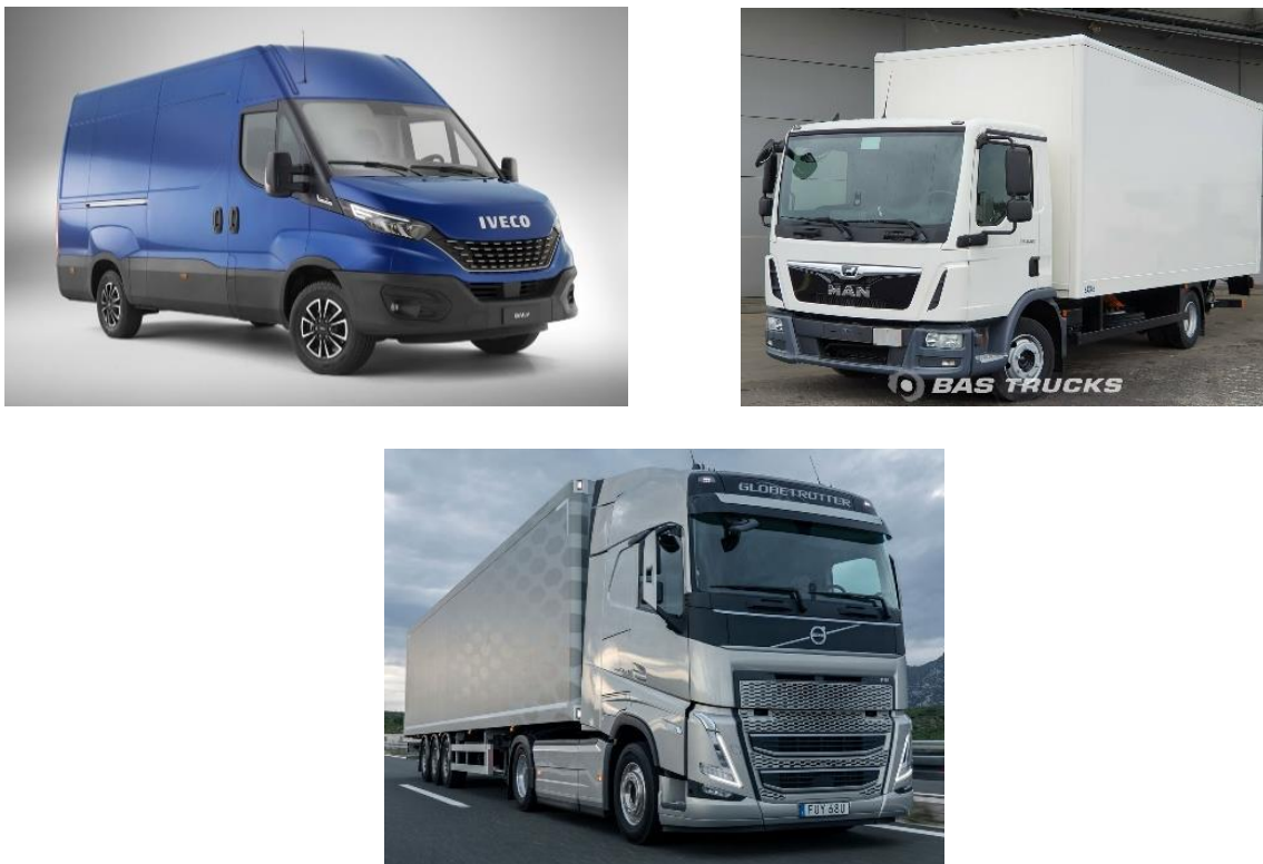
Slika 2. Primjer teretnog vozila kategorije N1 (gore lijevo), N2 (gore desno) i N3 (dolje)
