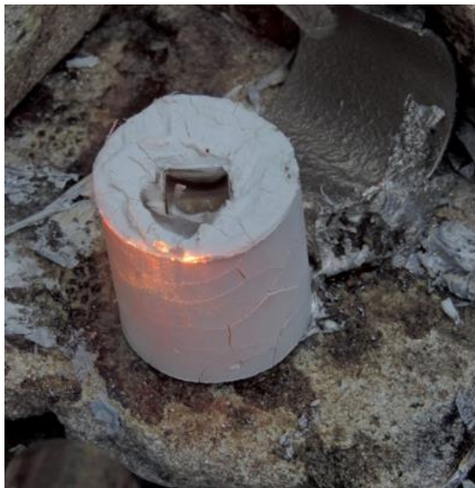
Slika 5.11. Zagrijani kalup u kojem je polimerna tvorevina rastaljena i kalupna šupljina napunjena rastaljenom mjedi [23]
