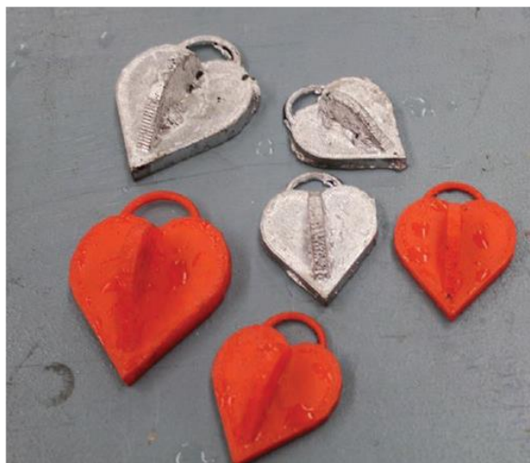
Slika 5.4. Prikaz mogućih nepravilnosti na spoju rebra i ostatka modela [23]
