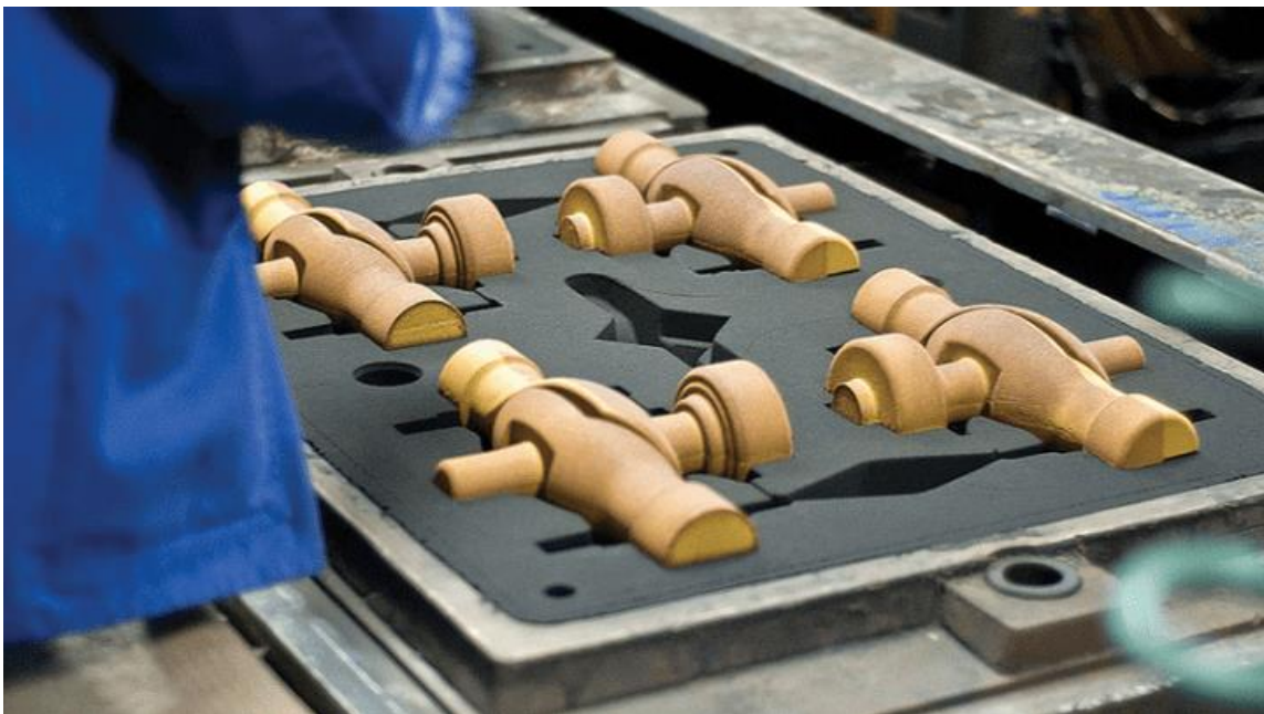
Slika 5.3. Primjer umetnutih jezgri prije nasipavanja pijeska [21]
