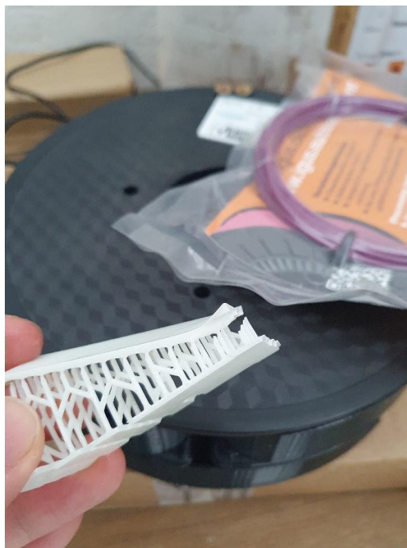
Slika 6.4. Pločica koja se uslijed nedovoljnog vremena ekspozicija odlijepila na početku ispisivanja
