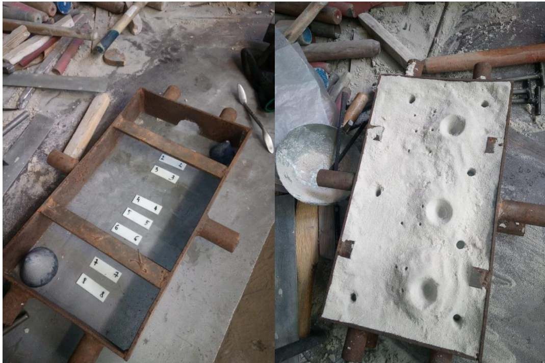
Slika 6.8.a., 6.8.b Pripremljena kalupna polovica za lijevanje testnih tvorevina
