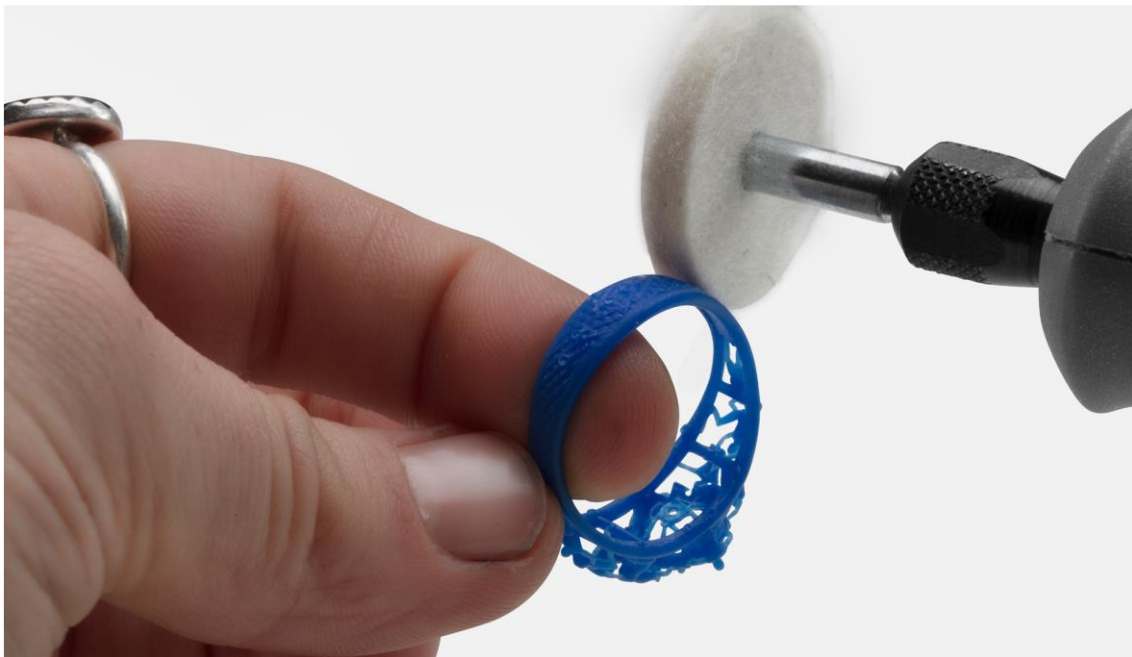
Slika 5.7. Naknadne operacije nakon DLP-a i skidanja potporne strukture [24]
