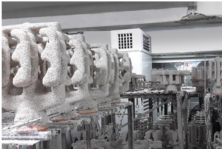
Slika 5.9. Zatvorene čahure kod preciznog lijevanja mogu biti jedino uklonjene razbijanjem keramičkog sloja [26]
