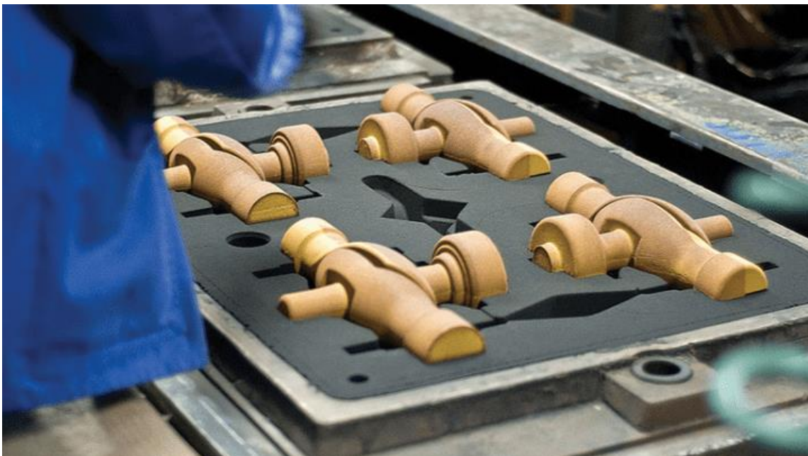
Slika 5.3. Primjer umetnutih jezgri prije nasipavanja pijeska [21]
