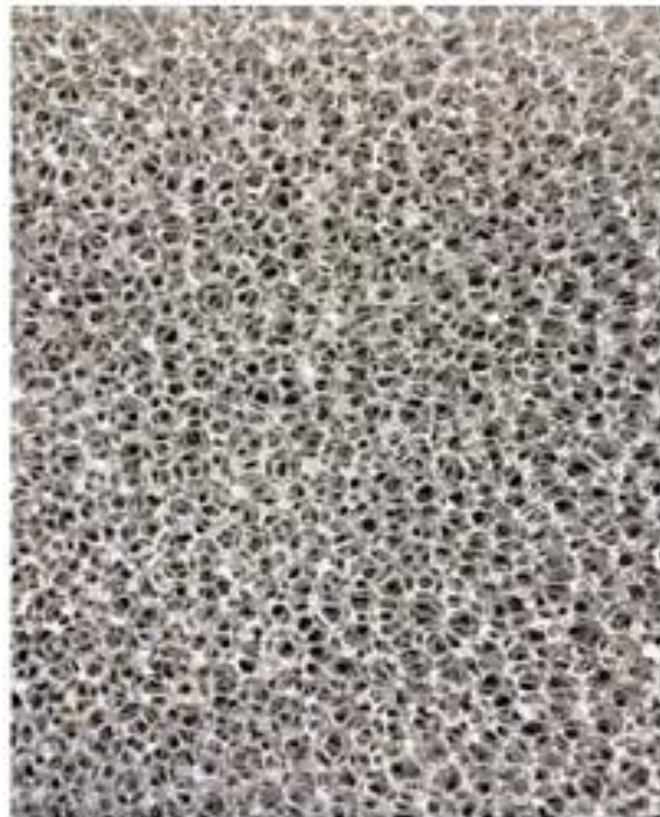
Slika 2.9.2 Prikaz mikrostrukture "ERG-Duocel" metalne pjene [6]
