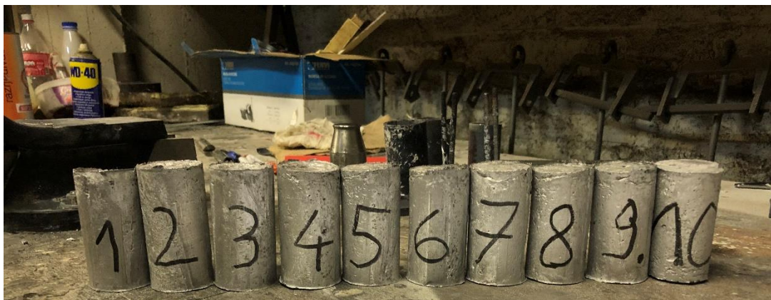
Slika 6.1.7 Uzorci aluminijeve pjene
