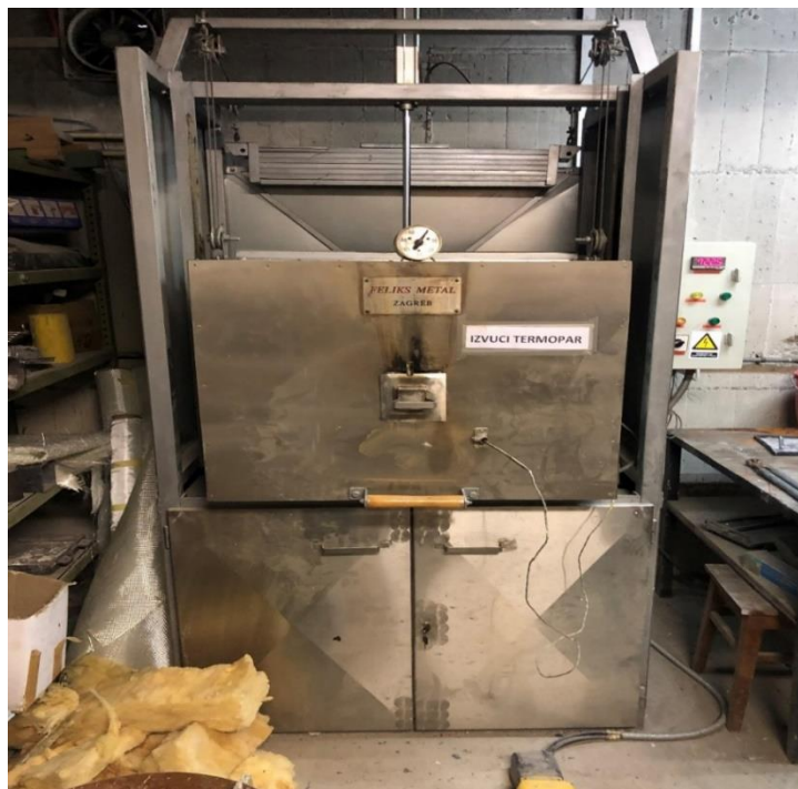
Slika 6.1.5 Elektrotopna zvonasta peć
