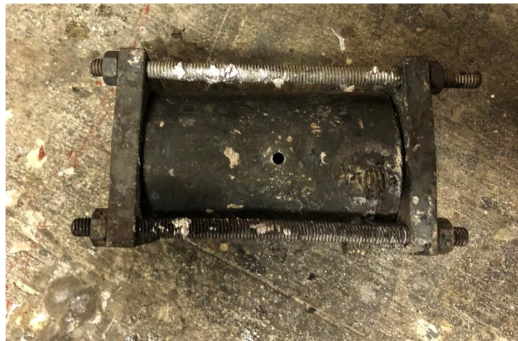
Slika 6.1.4 Sastavljeni kalup sa prekursorom
