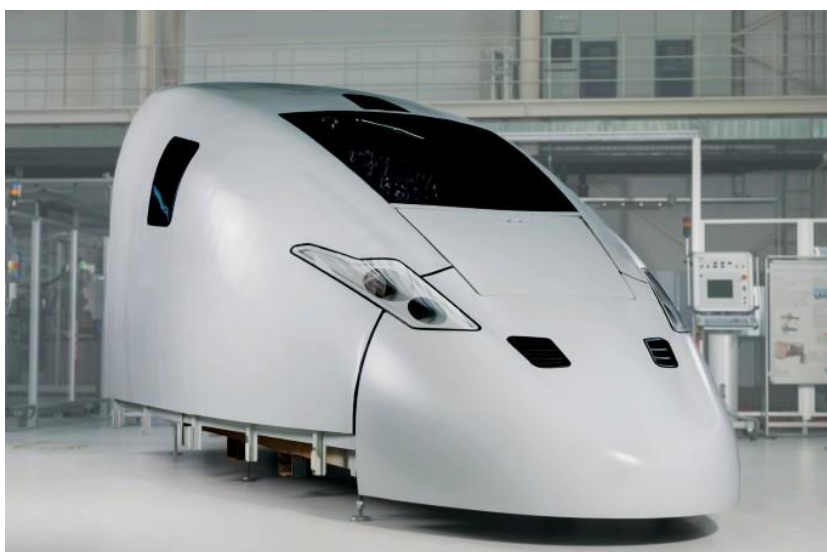
Slika 4.7.1 Prednji dio konstrukcije vlaka izrađen od kompozitnog sendviča s jezgrom od aluminijske pjene [14]
