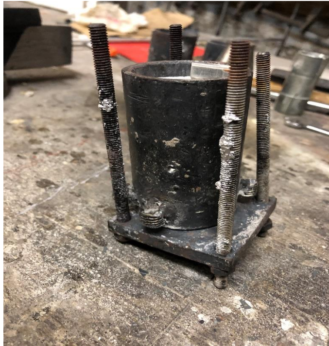
Slika 6.1.3 Rastavljeni kalup sa prekursorom
