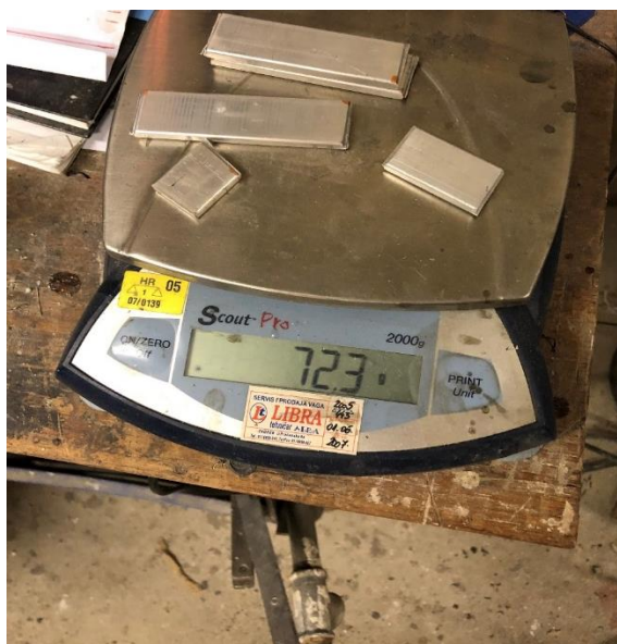
Slika 6.1.2 Vaganje aluminijskog prekursora
