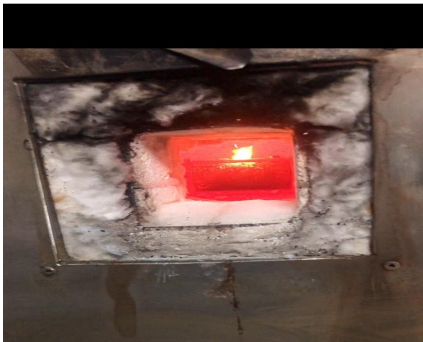
Slika 6.1.6 Trenutak istjecanja pjene iz kalupa
