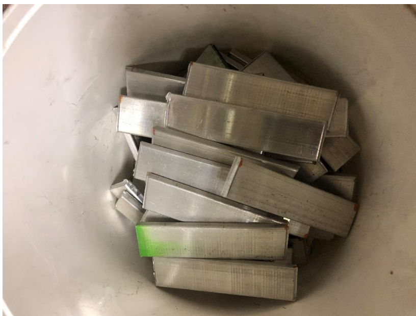
Slika 6.1.1 Korišteni prekursor sastava AlMgSi_{0,6} sa 0,4 mas % TiH_2
