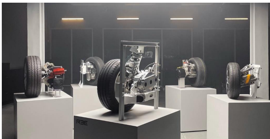
Slika 16. Pet postojećih konstrukcija REEcorner modula [11]
