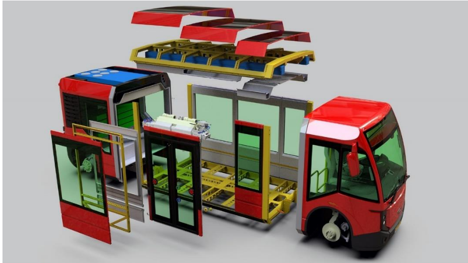
Slika 5. Prikaz konstrukcije središnjeg modula [5]
