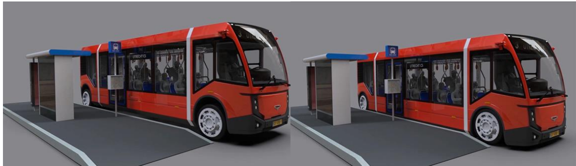
Slika 8. Prikaz spuštanja karoserije prilikom dolaska na stanicu [5]
