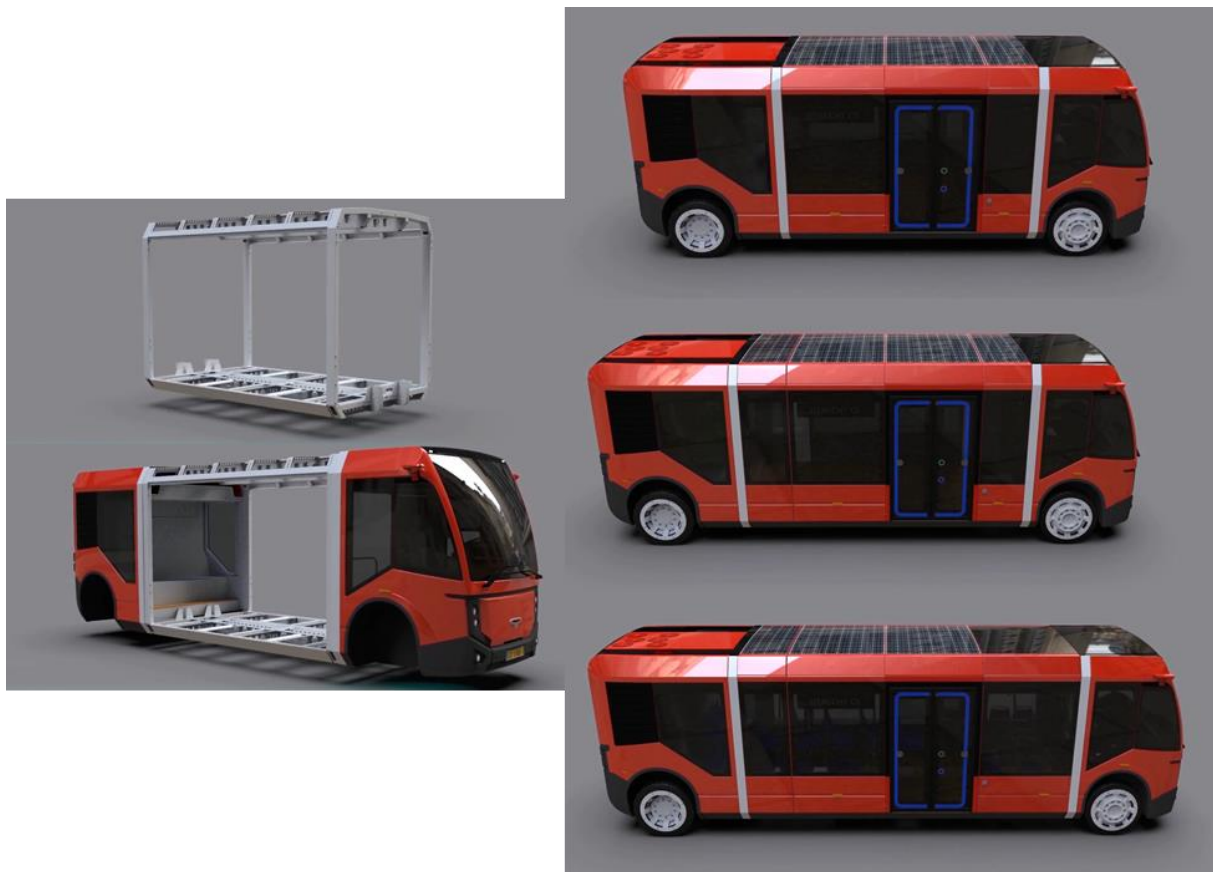
Slika 4. Modularna šasija i prikaz mogućih konfiguracija duljine [5]
