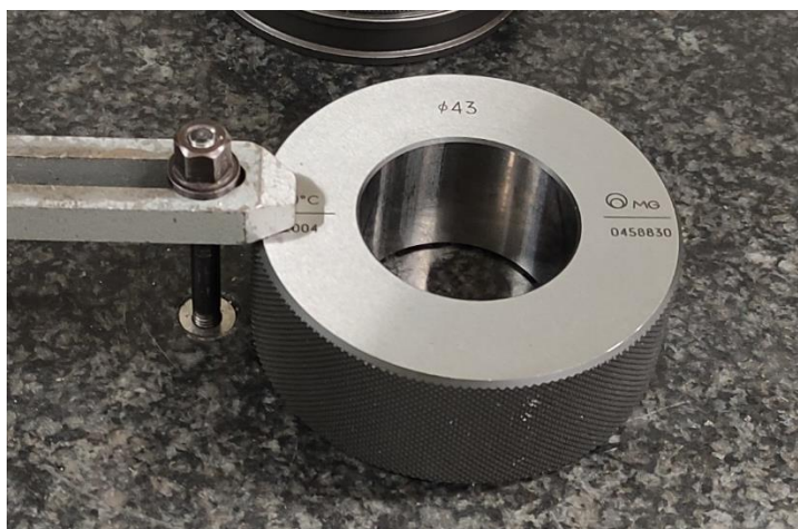
Slika 24. Mjerni prsten Ø 43 mm, proizvođač ZEISS, oznaka: RET 118-225
