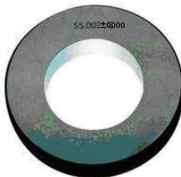
Slika 7. Granično mjerilo za osovinu [8]
