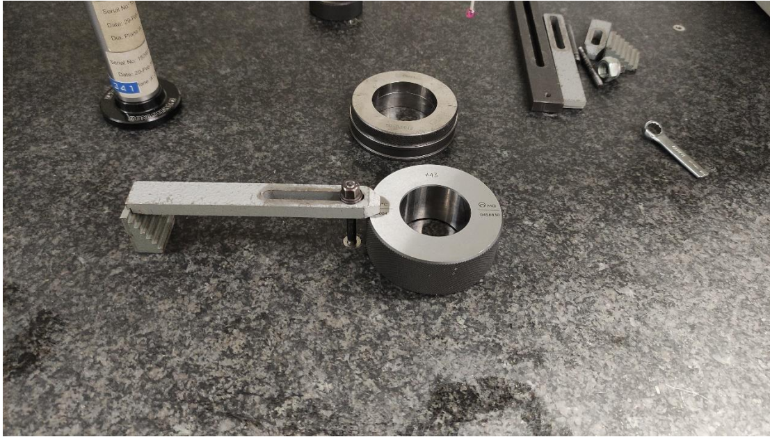
Slika 16. Postavljanje prstena na granitni stol
