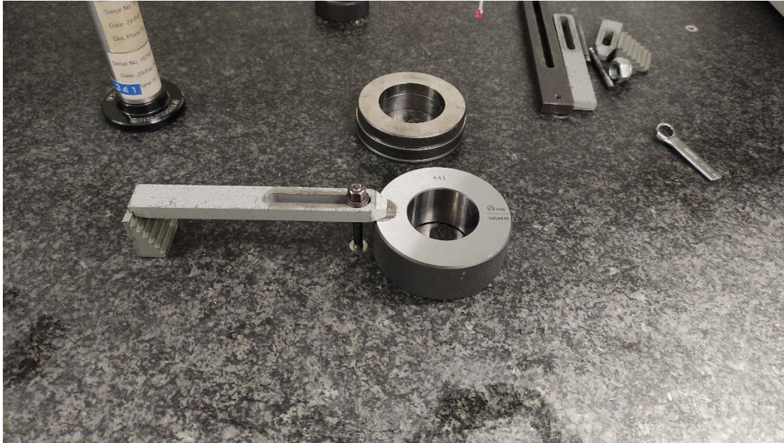
Slika 16. Postavljanje prstena na granitni stol
