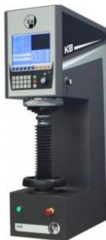
Slika 4. Uređaj (tvrdomjer) za ispitivanje tvrdoće po Rockwell-u. Model KB 150 R [5]
