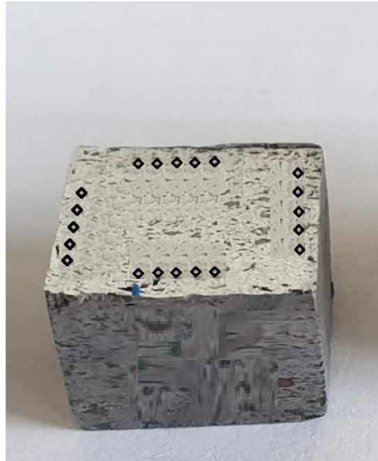
Slika 30. Mjesta ispitivanja tvrdoće uz rubove
