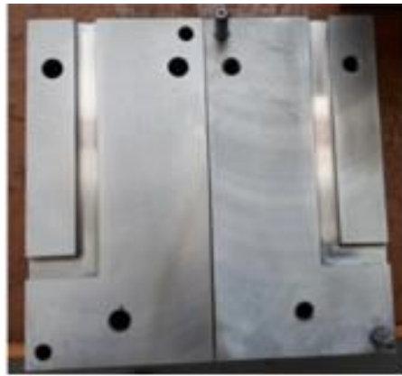
Slika 20. Alat za kutno kanalno prešanje
