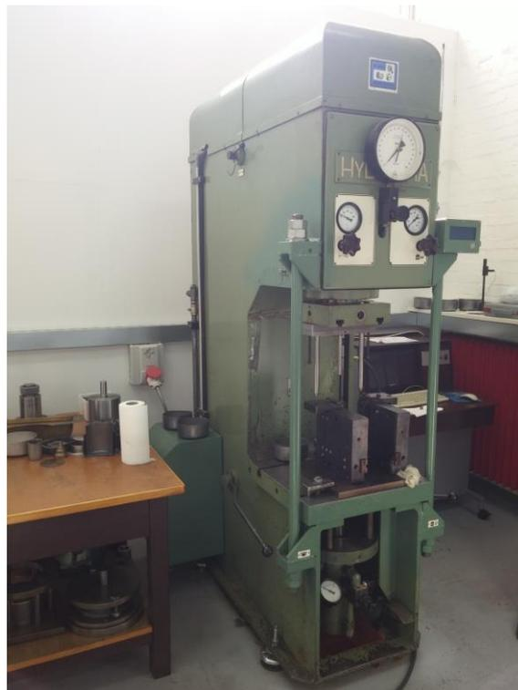
**Slika 21. Hidraulička preša**
