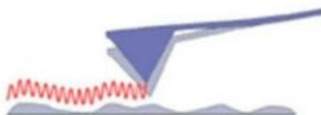
Slika 16. Shematski prikaz rada beskontaktna metode AFM-a [32]
