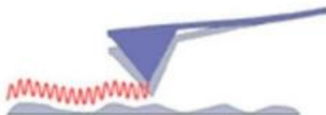
Slika 16. Shematski prikaz rada beskontaktna metode AFM-a [32]
