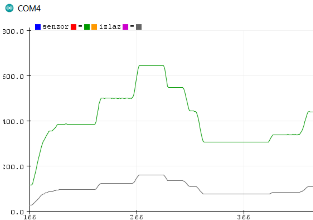
Slika 32. Rezultat upravljanja potencijometrom i vrijednost izlaznog PWM signala
