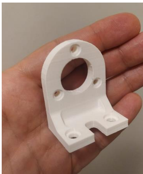
Slika 17. 3D isprintan nosač enkodera
