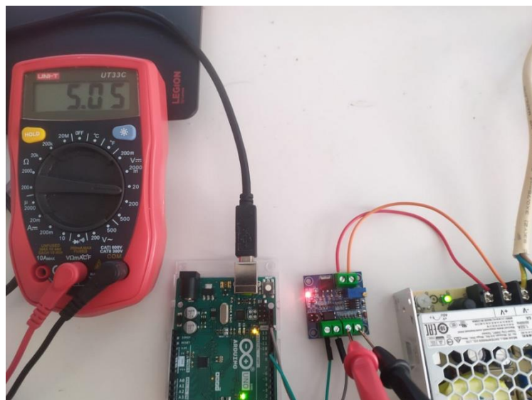
Slika 28. Ispitivanje modula s proizvoljnim radnim ciklusom PWM signala
