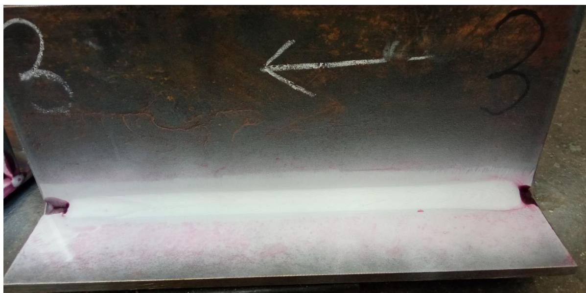
Slika 45. Ispitivanje površinskih pukotina, uzorak 3
