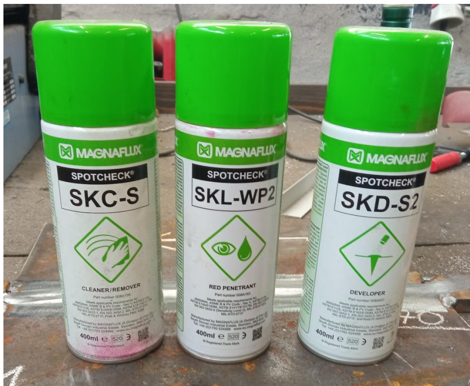
Slika 41. Čistač, penetrant i razvijач proizvođača Magnaflux
