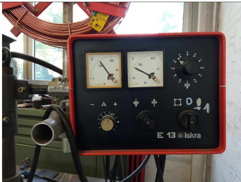
Slika 29. Upravljačka jedinica uređaja za zavarivanje
