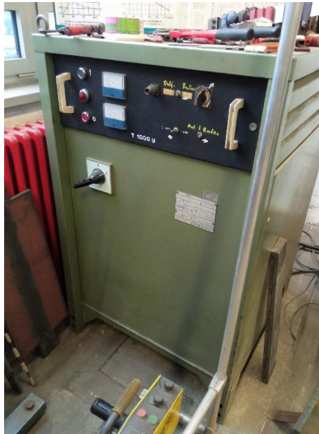
Slika 27. Izvor struje korišten za EPP zavarivanje
