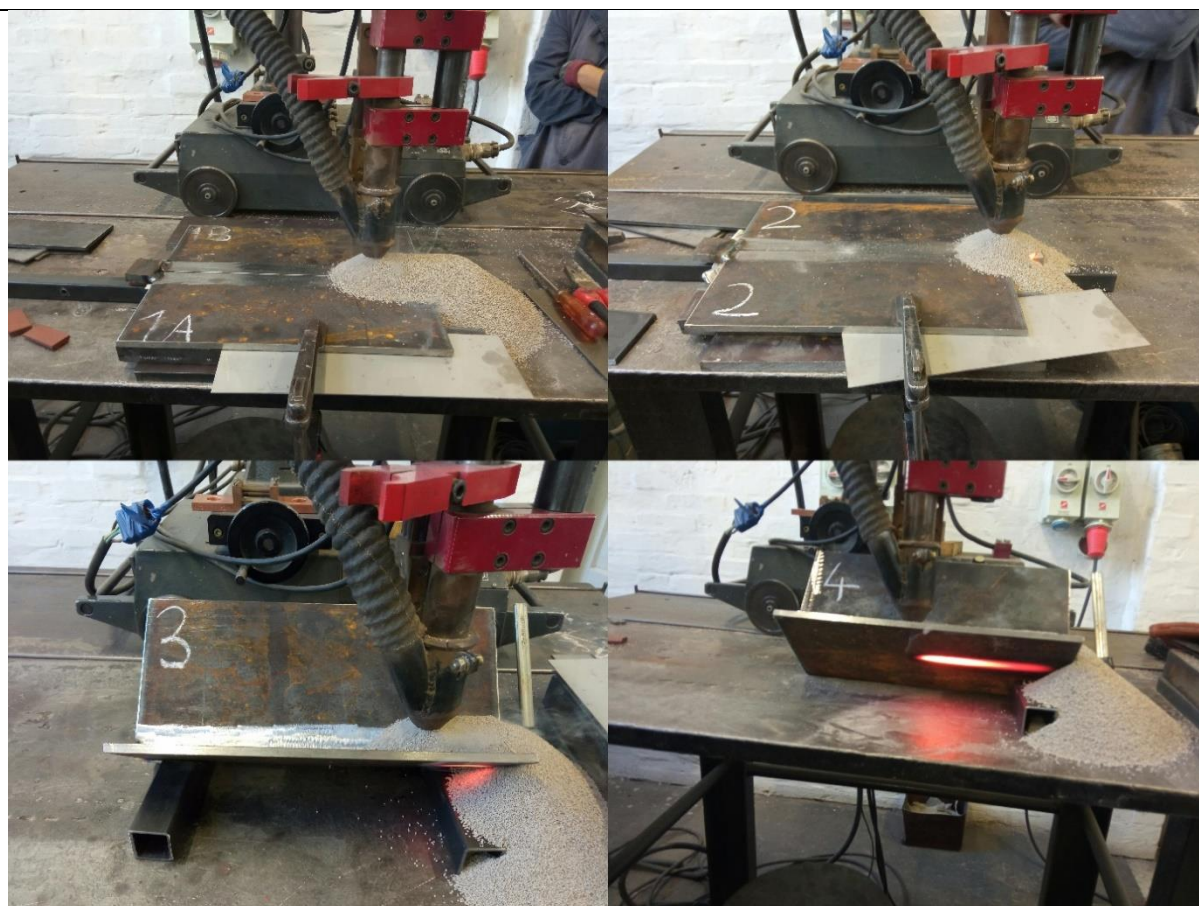
Slika 36. Postupak EPP zavarivanja 4 ispitna uzorka
