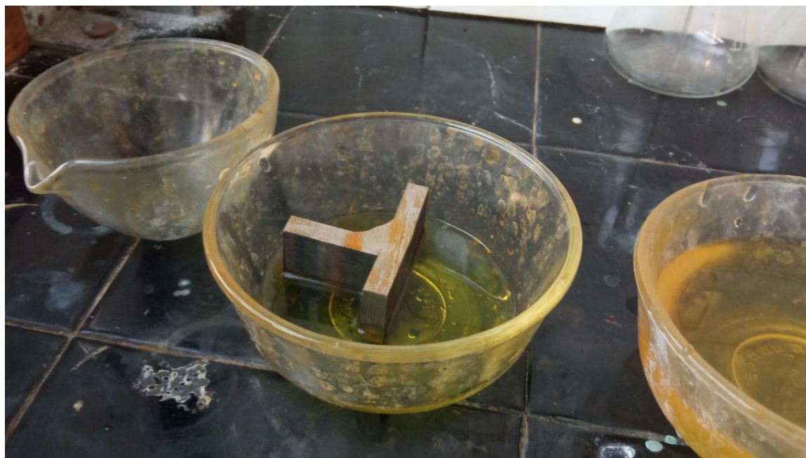
Slika 53. Nagrizzanje uzoraka u otopini nitala
