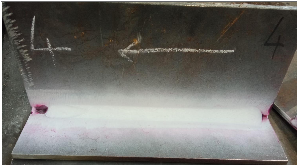
Slika 46. Ispitivanje površinskih pukotina, uzorak 4
