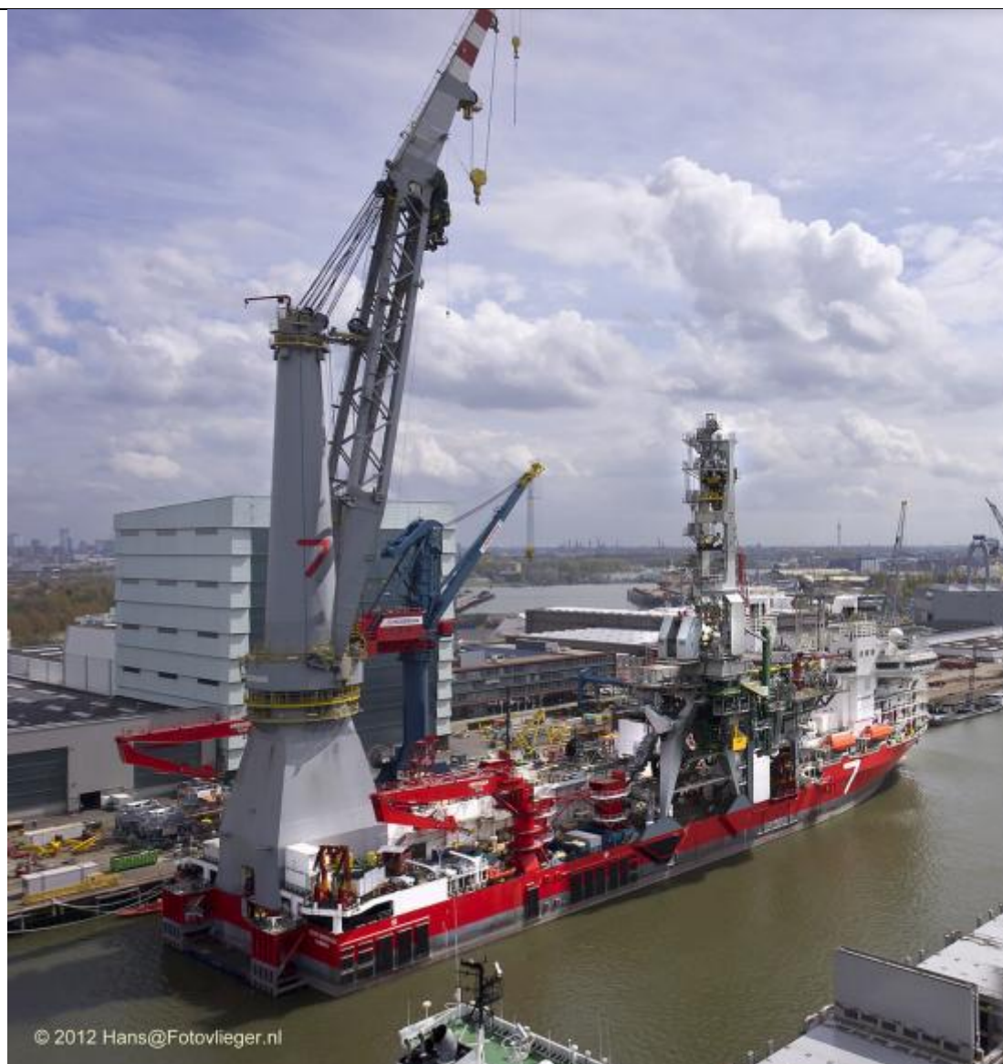
Slika 4. Dizalica od čelika S690QL [9]
