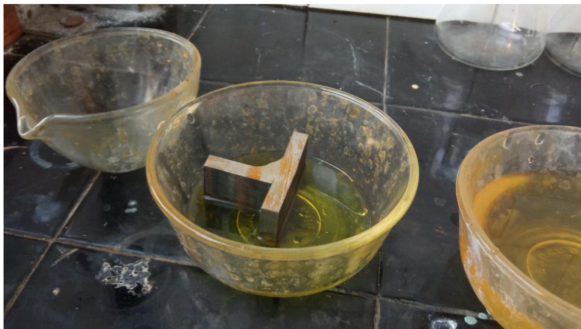
Slika 53. Nagrizanje uzoraka u otopini nitala
