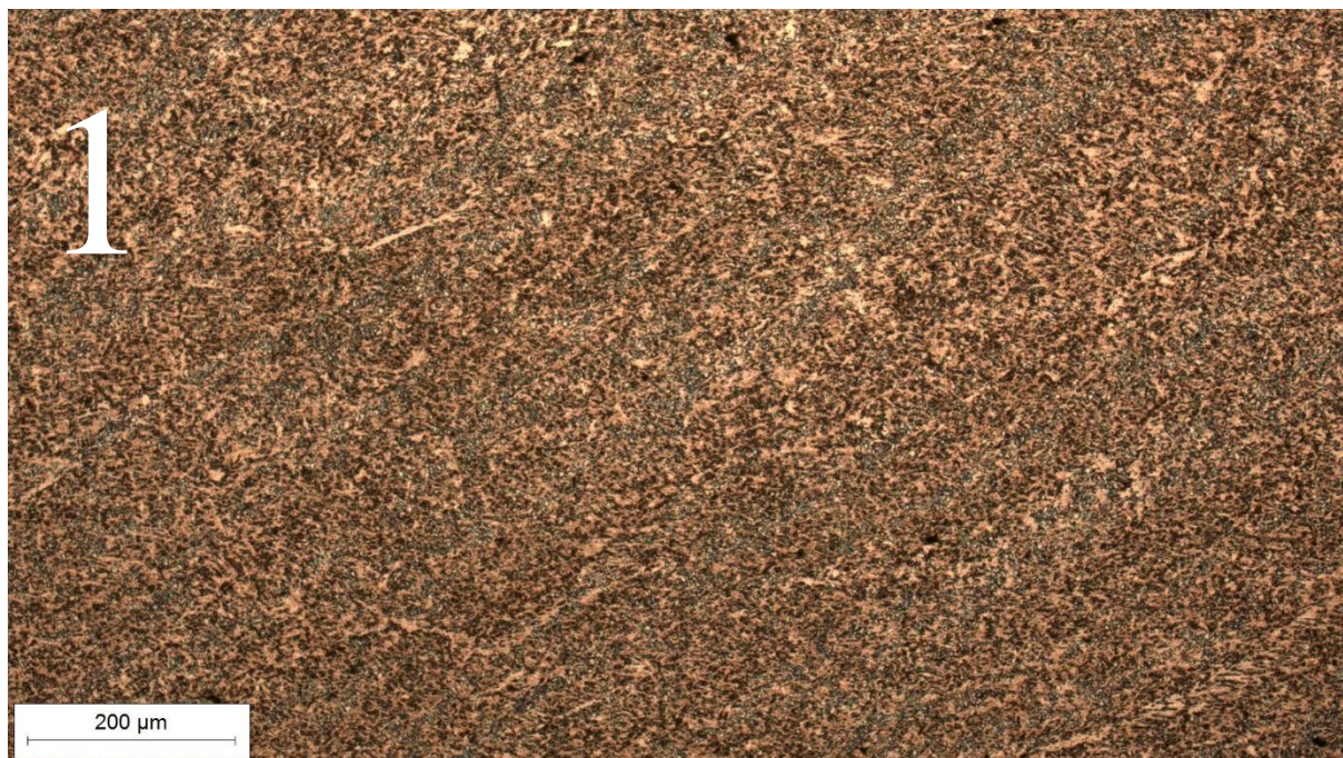
Slika 51. Mikrostruktura metala zavara, Uzorak 1
