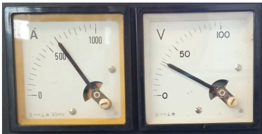
Slika 35. Iznosi struje i napona zavarivanja
