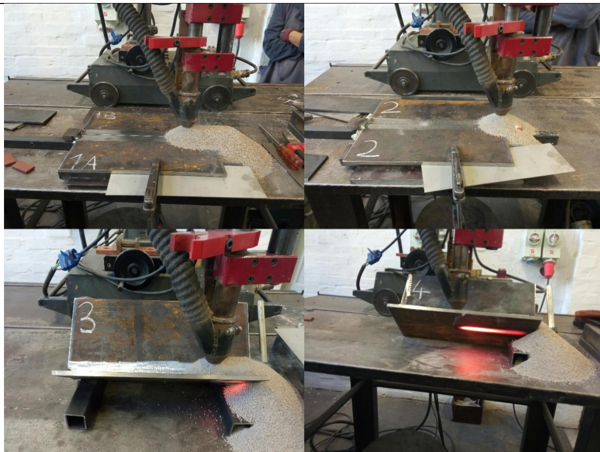
Slika 36. Postupak EPP zavarivanja 4 ispitna uzorka
