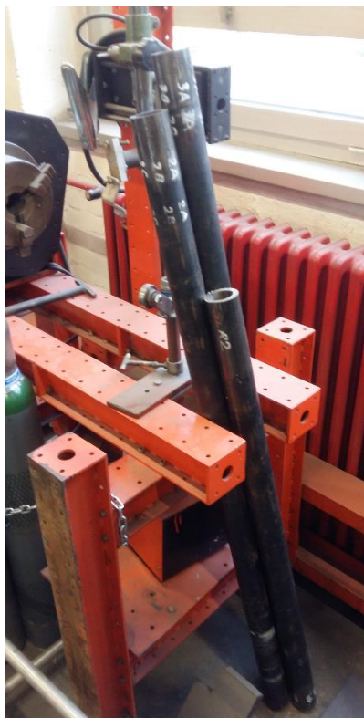
Slika 54. Cijevi čelika P91 korištene u postupku zavarivanja
