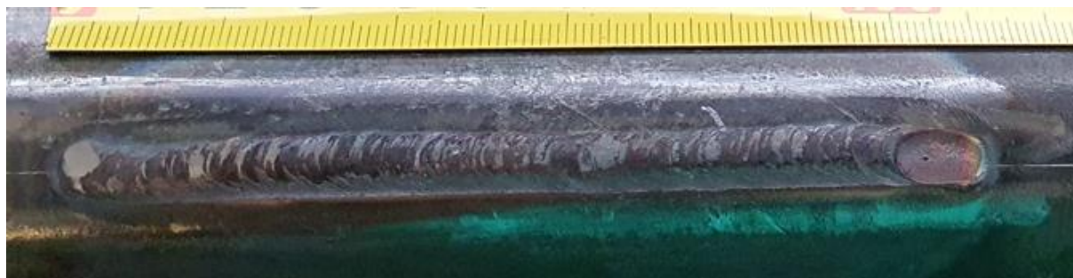
Slika 60. Referentni uzorak R1 pretaljivan istosmjernom strujom
