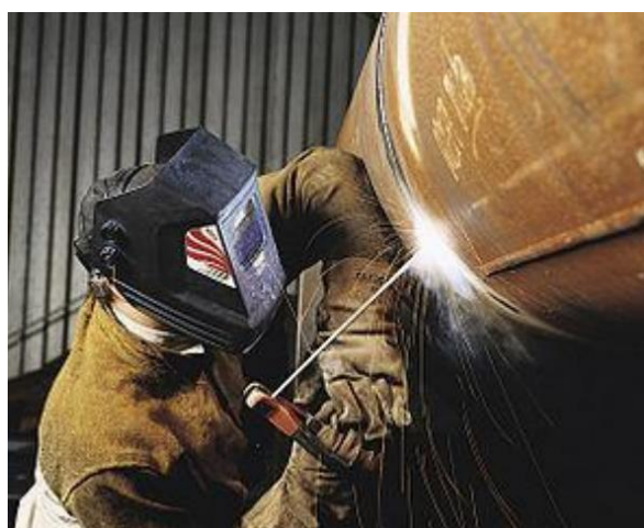
Slika 43. REL postupak zavarivanja [22]
