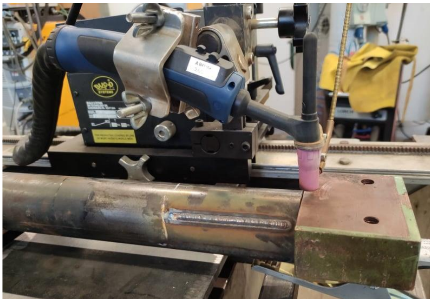
Slika 59. Položaj pištolja i cijevi čelika P91 u postupku zavarivanja
