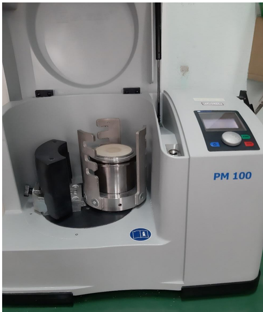
Slika 15. Planetarni kuglični mlin (PM 100, Retsch GmbH, Njemačka)
