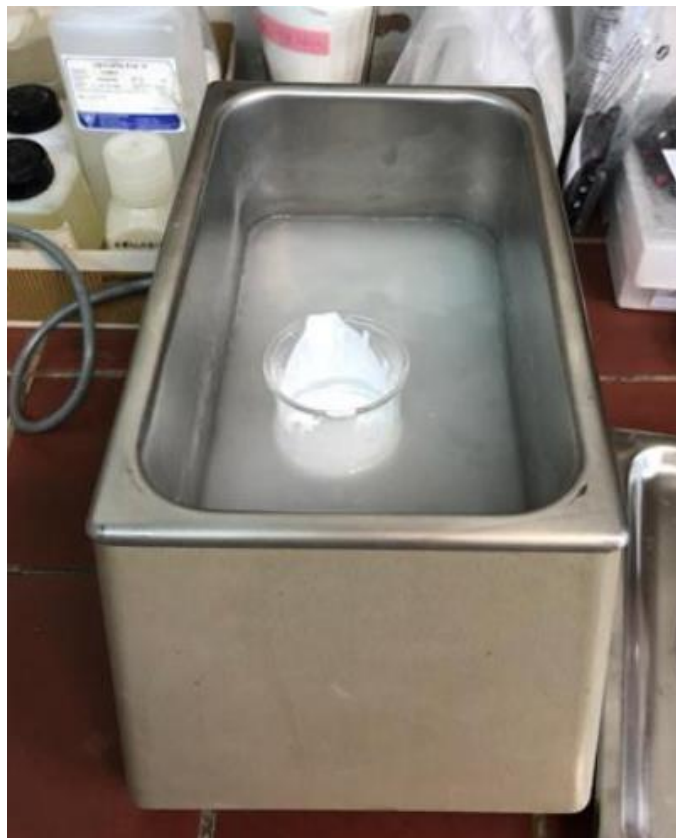
Slika 16. Tretiranje suspenzije u ultrazvučnoj kupelji BRANSONIC 220 (Branson Ultrasonics Corp., SAD)
