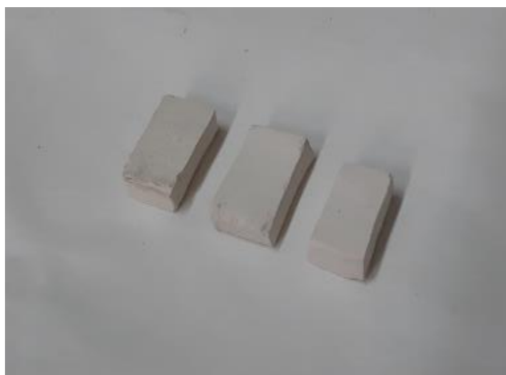
Slika 19. Sirovci dobiveni nakon lijevanja suspenzija, sušenja i brušenja
