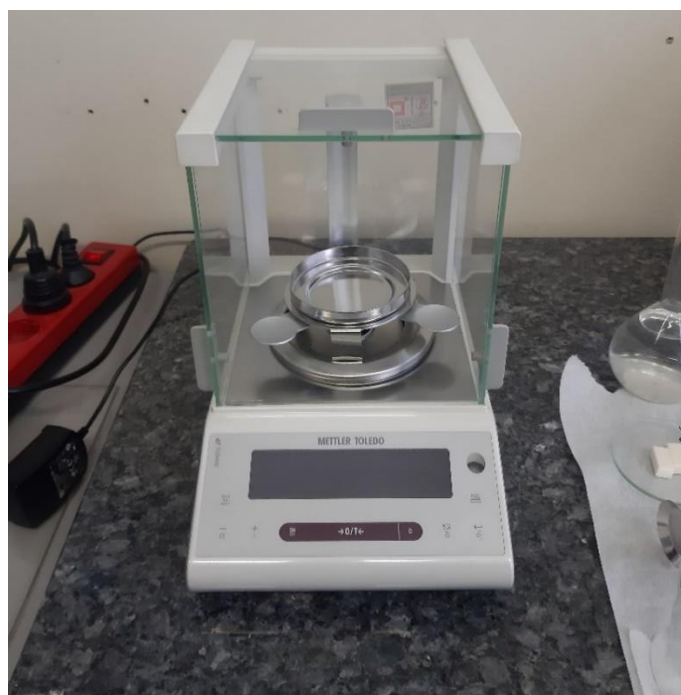
Slika 25. Arhimedova vaga Mettler Toledo (Mettler Toledo GmbH, Švicarska)
