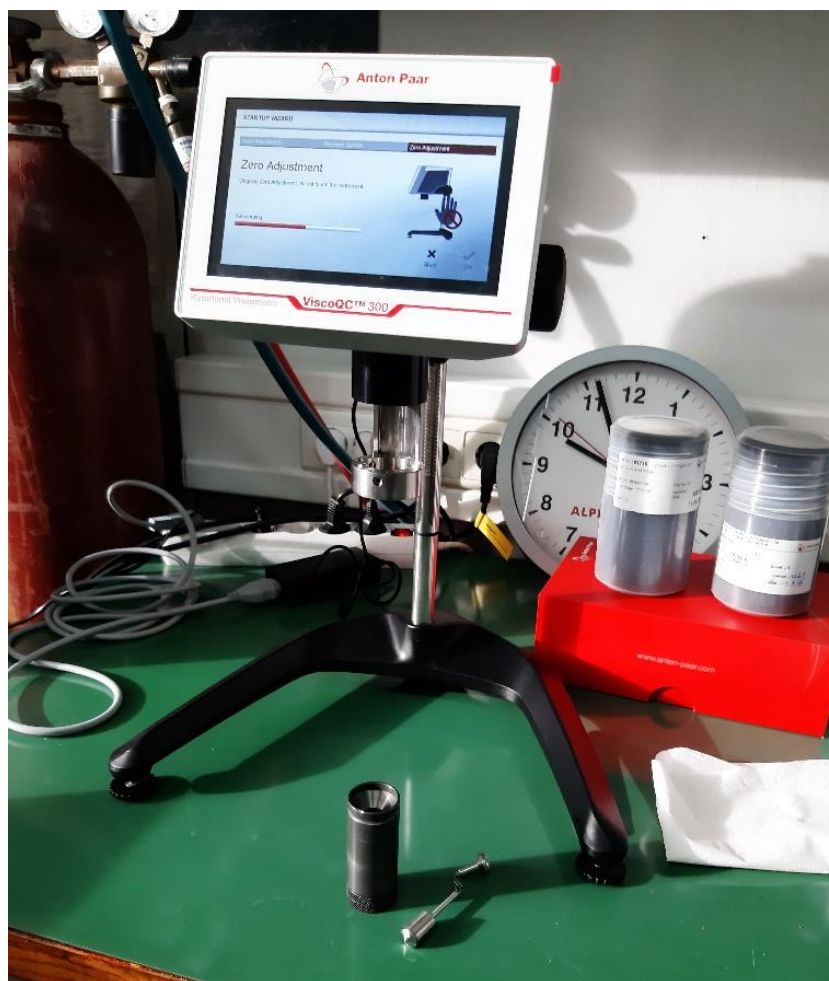
Slika 17. Rotacijski viskozimetar – Anton Paar ViscoQC 300
