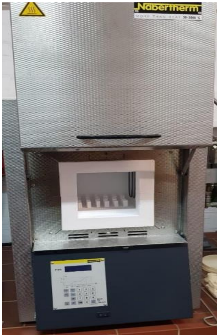
Slika 20. Laboratorijska peć za sinteriranje Nabertherm P310 (Nabertherm GmbH, Njemačka)
