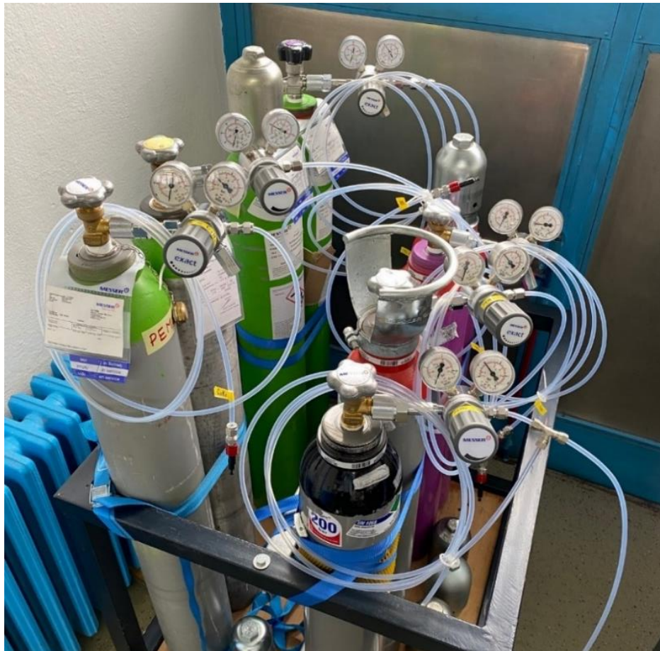
Slika 36. Plinovi korišteni za kalibraciju mjernog sustava
