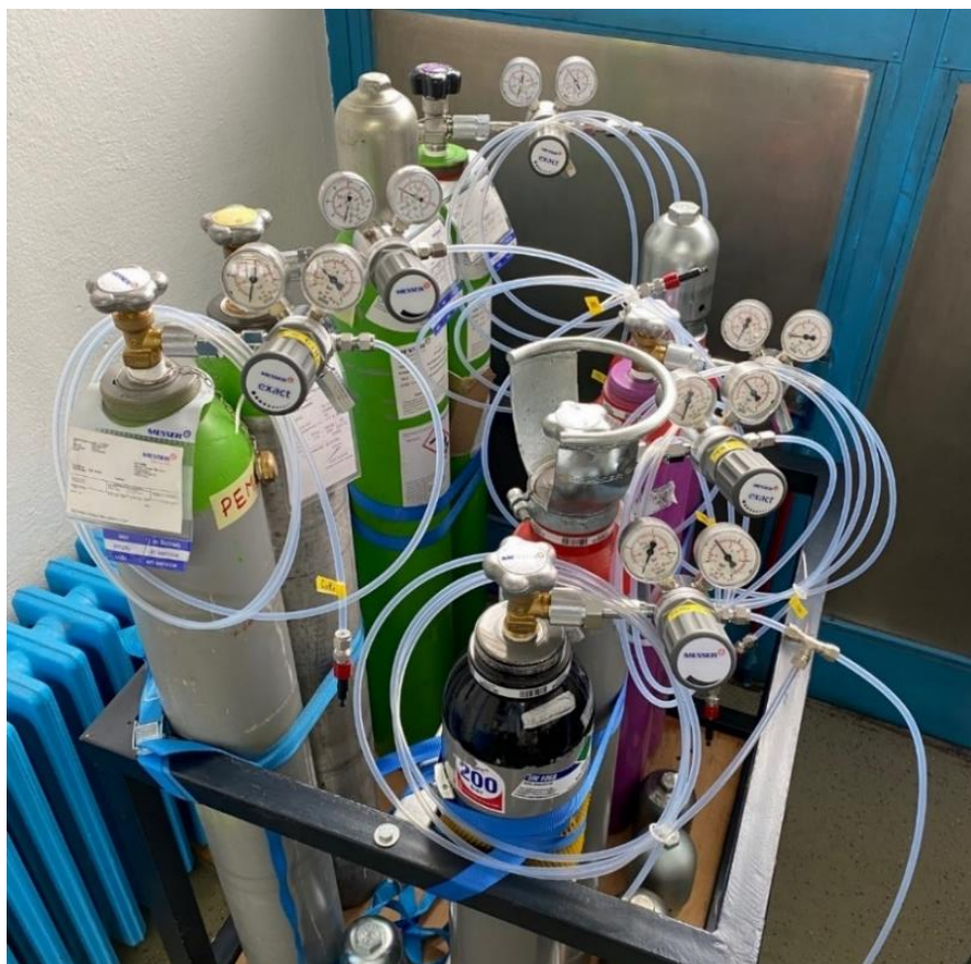
Slika 6.2.3.5.1. Plinovi za kalibraciju mjernog sustava
