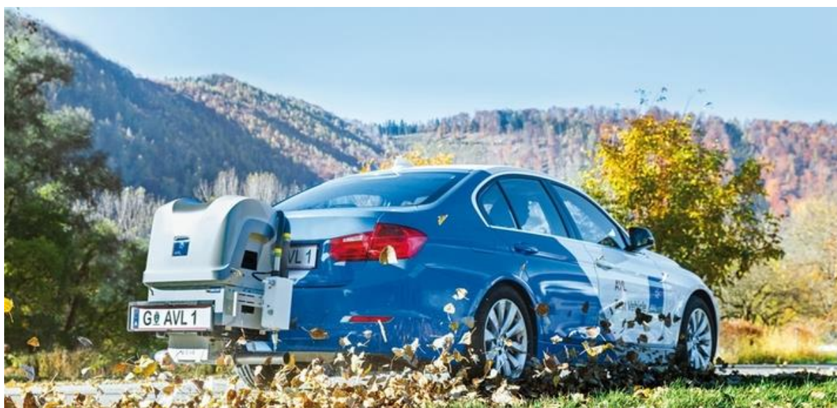
Slika 11. PEMS uređaj tvrtke AVL ugrađen na vozilo [6]
