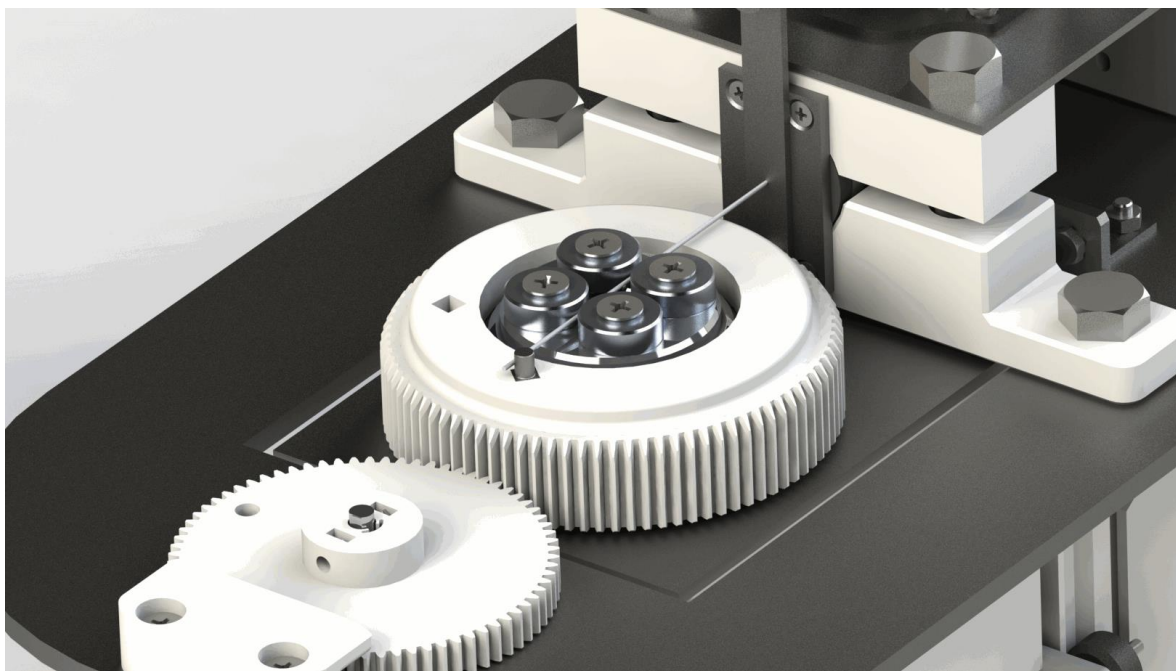
Slika 28. Sustav savijanja žice
