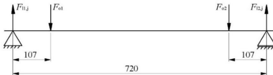
Slika 46. Opterećenje osovine ježa
