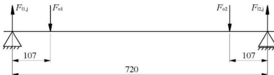
Slika 46. Opterećenje osovine ježa
