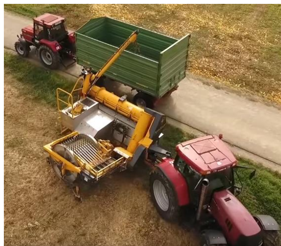
Slika 18. Kombajn za bundeve AGRO STAHL AXR 325 u poziciji za pražnjenje spremnika [14]
