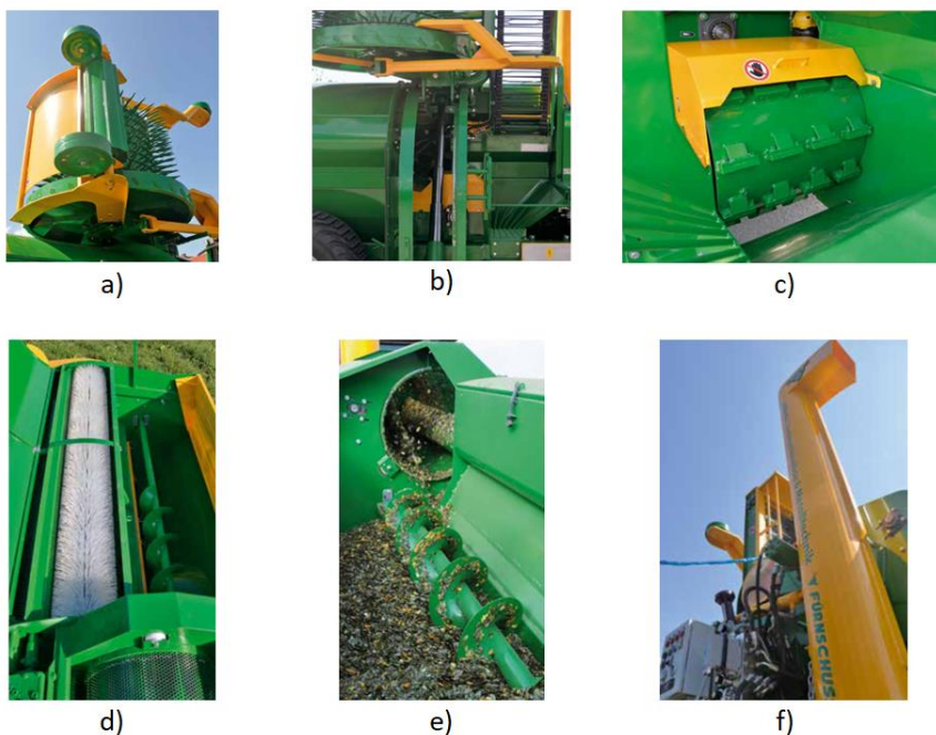
Slika 20. Tehnička rješenja mehanizama na kombajnu za bundeve Green Bull MASTER: a) hidraulički pogonjeni valjak; b) hidraulički cilindar za podizanje i spuštanje ježa; c) drobilica; d) gumena četka za transport sjemenki iz bubnja za odvajanje sjemenki u perforirani bubanj za dodatno čišćenje; e) puž za ravnomjerno raspoređivanje sjemenki u spremniku; f) elevator za transport sjemenki iz spremnika u prikolicu [15]
