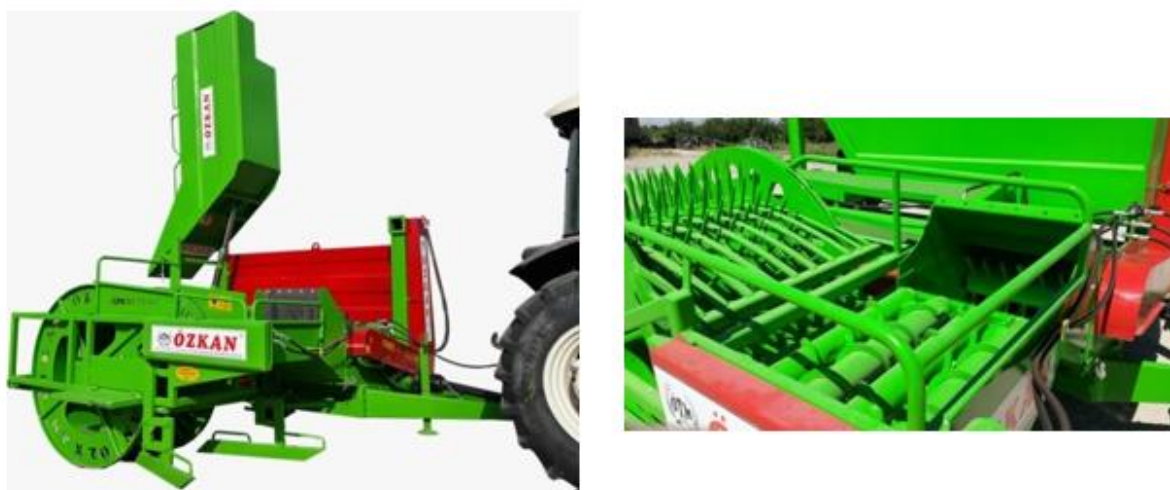
Slika 12. Kombajn za bundeve Özkan Tarim Makina s ježom (lijevo) i mehanizam vođenja bundevi od ježa do drobilice (desno) [10]
