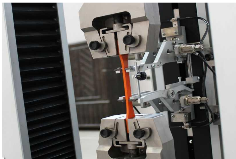
Slika 3.2. Ispitivanje rasteznih svojstava [10]
