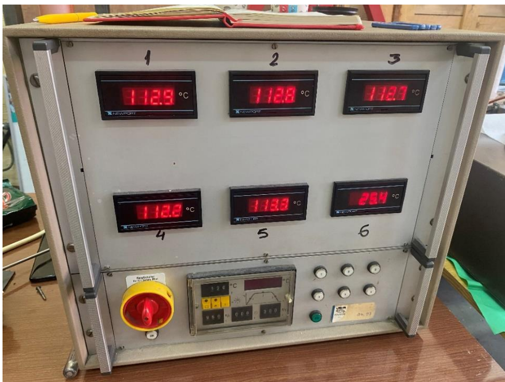
Slika 5.2. Uređaj za prikaz temperatura u uljnoj kadi
