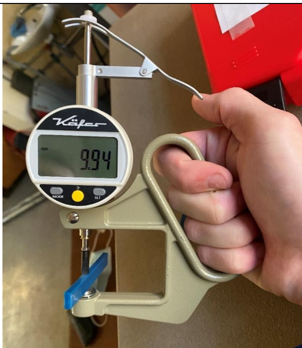
Slika 5.10. Mjerenje širine ispitnog tijela
