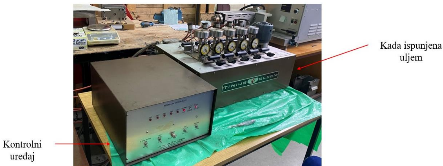
Slika 5.1. Kada ispunjena uljem i kontrolni uređaj
