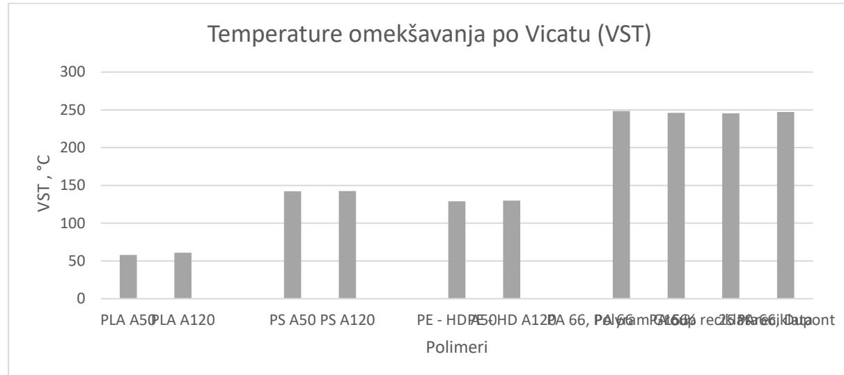
**Slika 5.20. Usporedba dobivenih rezultata temperature omekšavanja i polimera**
