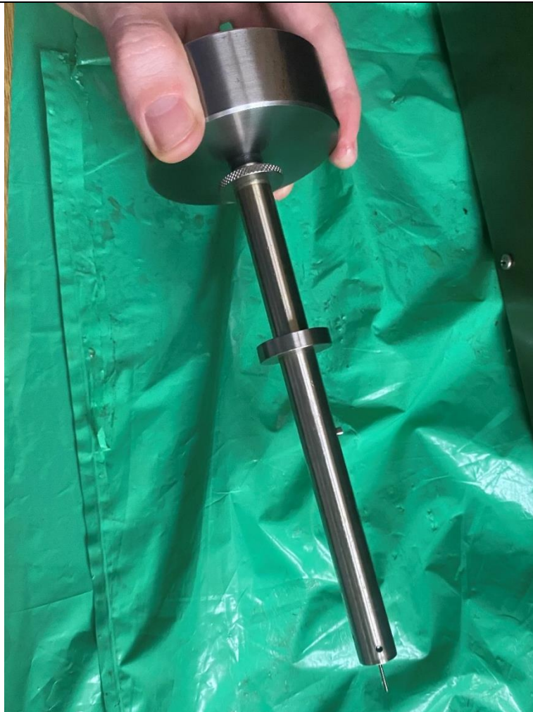
Slika 5.7. Uteg, klip i penetrator
