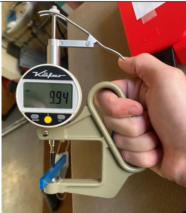
Slika 5.10. Mjerenje širine ispitnog tijela
