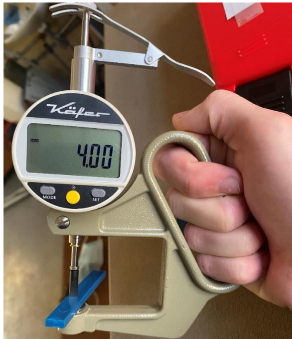
Slika 5.9. Mjerenje debljine ispitnog tijela
