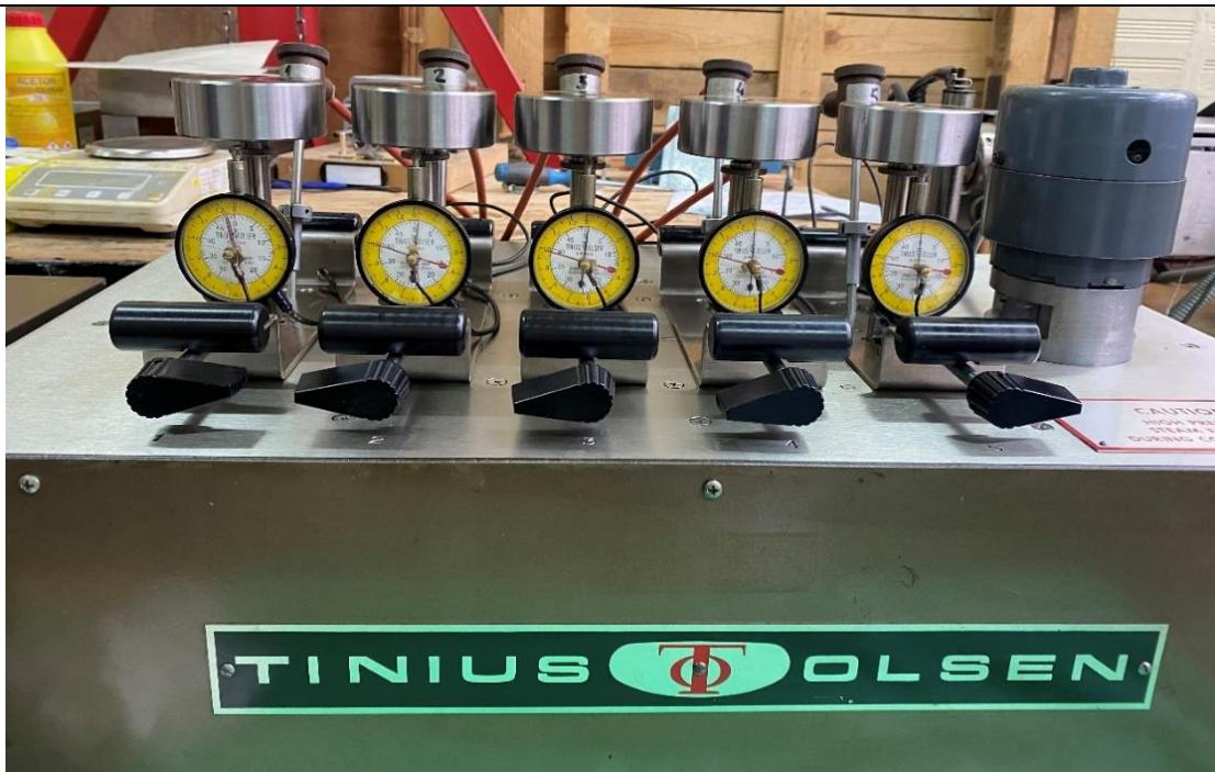
Slika 5.4. Kada za ispitivanje ispunjena uljem
