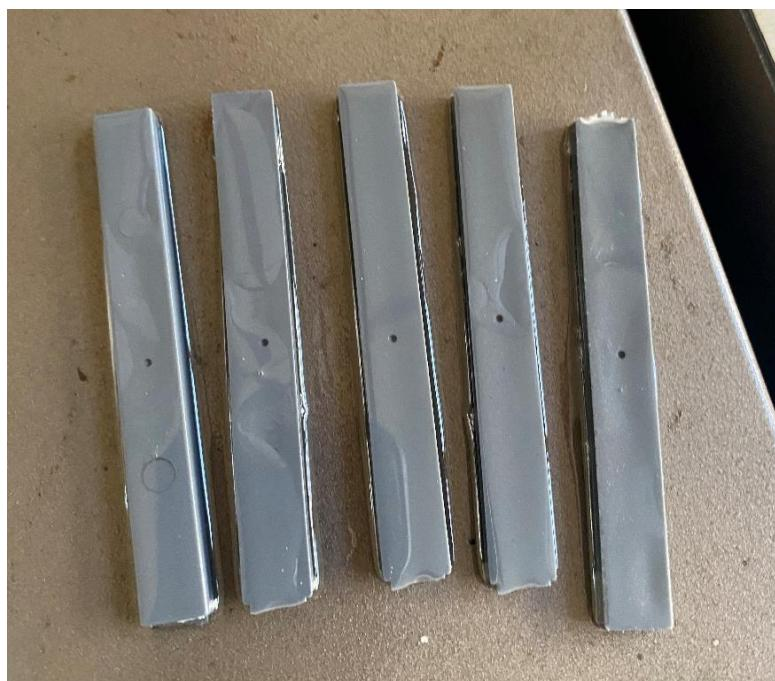
**Slika 5.15. Ispitna tijela PS nakon provedenog ispitivanja metodom A50**
