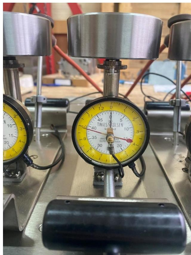
Slika 5.5. Prikaz uređaja za mjerjenje penetracije
