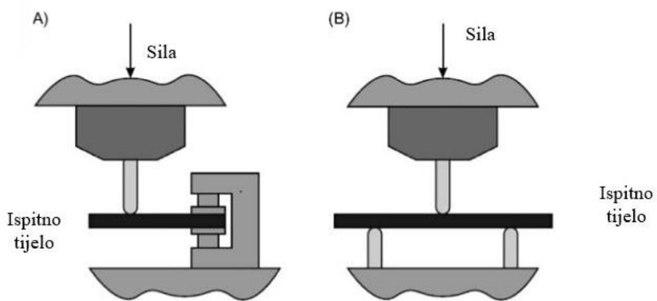
Slika 3.5. Prikaz dva primjera savojnog ispitivanja [7]
