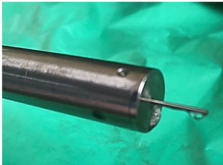
Slika 5.7. Uteg, klip i penetrator
