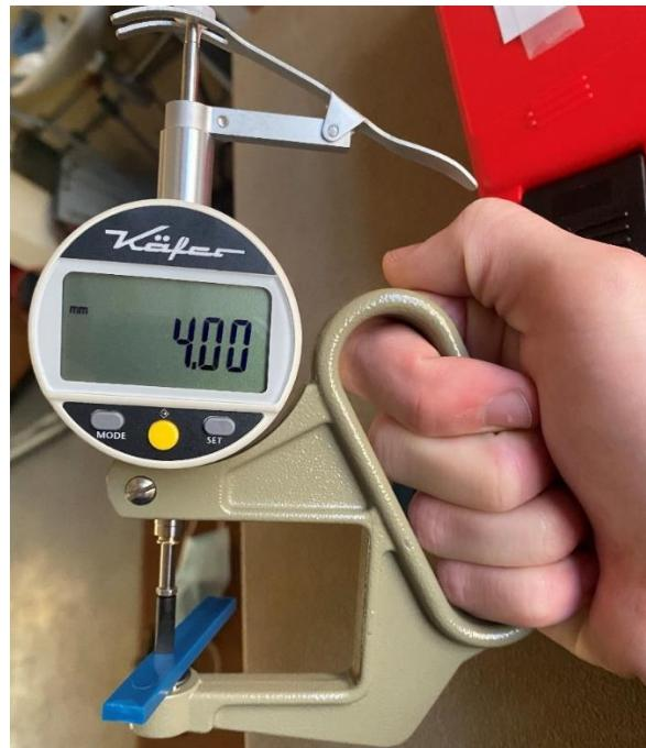
Slika 5.9. Mjerjenje debljine ispitnog tijela
