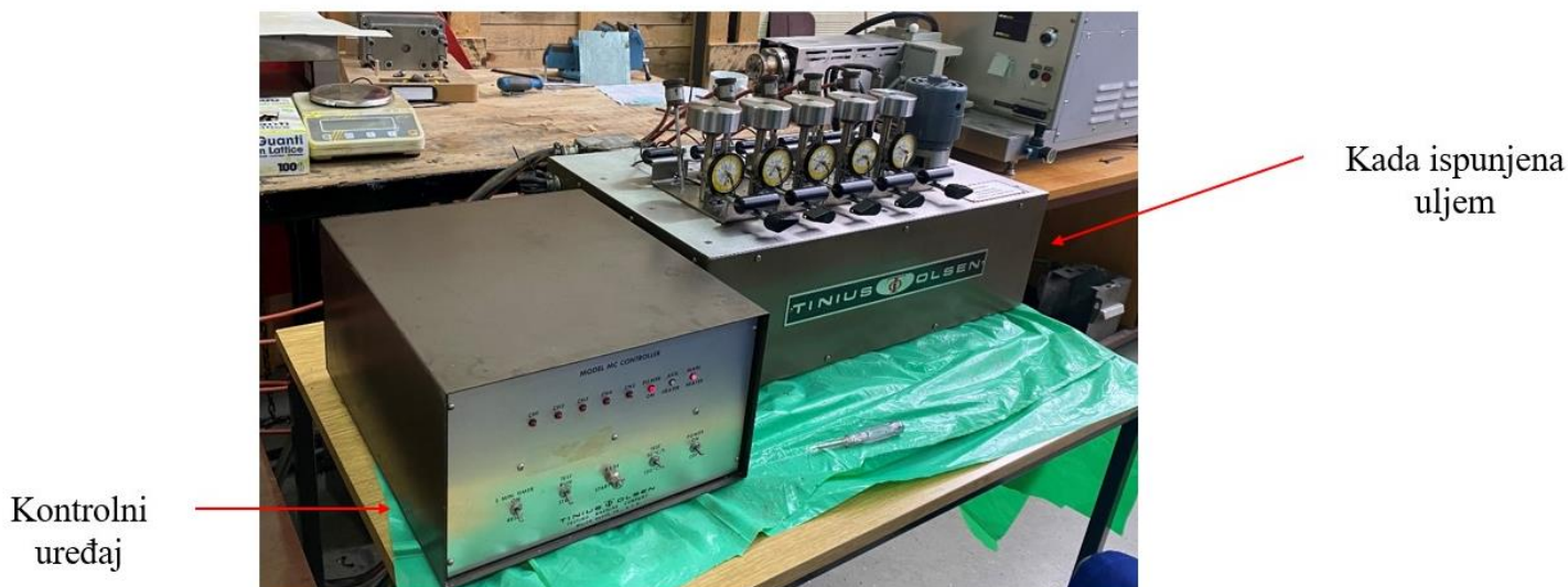
Slika 5.1. Kada ispunjena uljem i kontrolni uređaj
