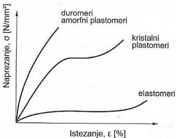
Slika 3.4. Dijagram naprezanje - istezanje glavnih skupina polimernih materijala [12]
