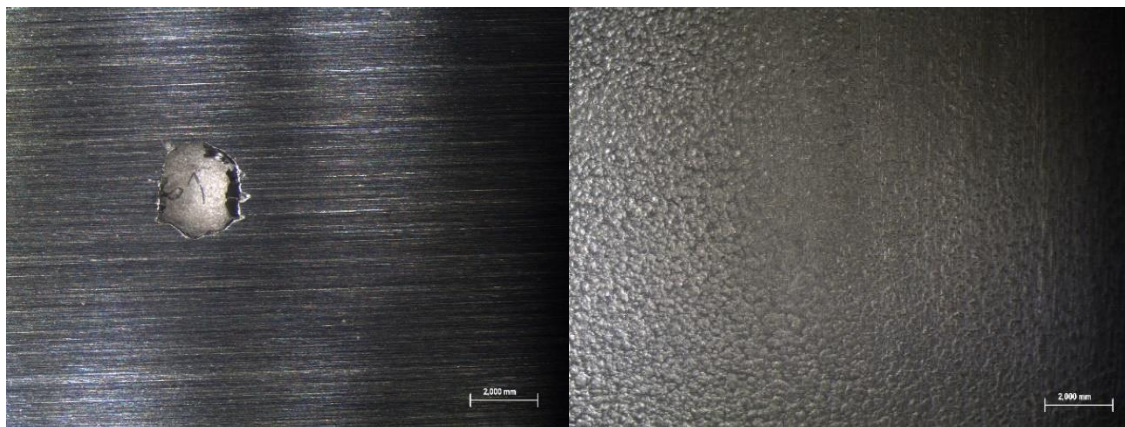
Slika 22. Usporedba površine austenitnog čelika EN 1.4404 (AISI 316L) i superaustenitnog čelika EN 1.4539 (AISI 904L) nakon korozijskog ispitivanja na 20 °C
