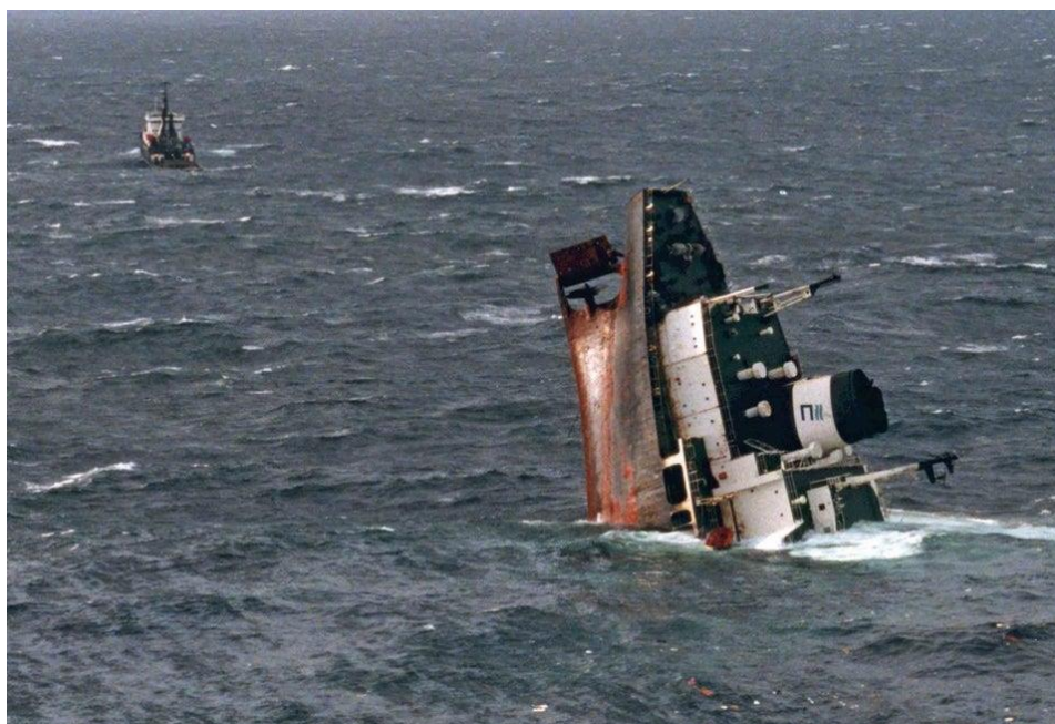
Slika 8. Havarija tankera Erika uslijed korozije [14]
