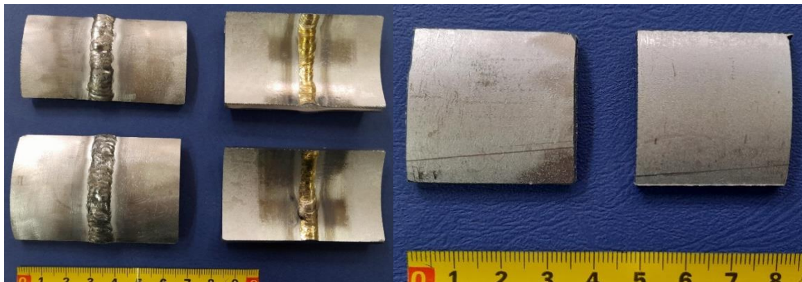
Slika 23. Svi uzorci čelika EN 1.4547 (254 SMO) nakon korozijskog ispitivanja
