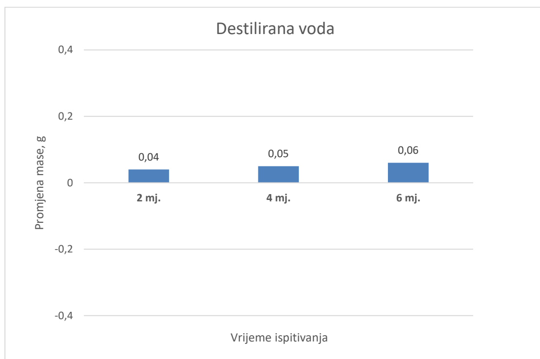
Slika 31. Promjene mase kod uzoraka tretiranih destiliranom vodom
