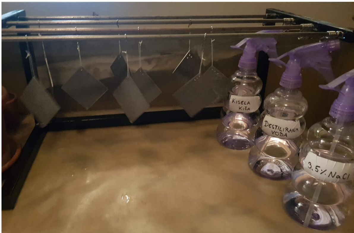
Slika 19. Ispitni uzorci na metalnom stalaku
