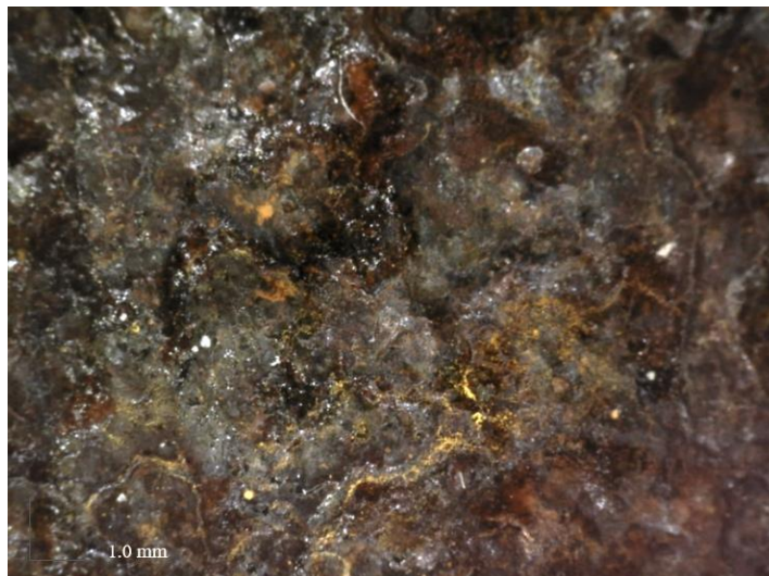
Slika 37. Površina uzorka tretiranog morskom vodom nakon 6 mjeseca
