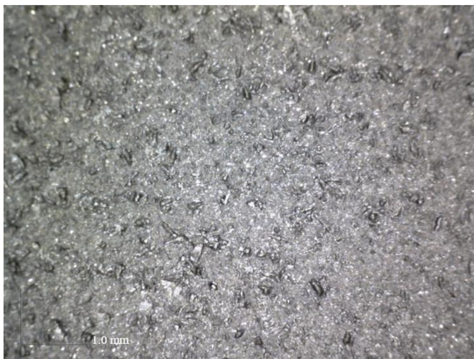
Slika 25. Površina Corten čelika prije provedenih ispitivanja ( Dino-Lite )
