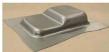
Slika 13. Kutijasti proizvodi dobiveni postupkom dubokog vučenja [12]
