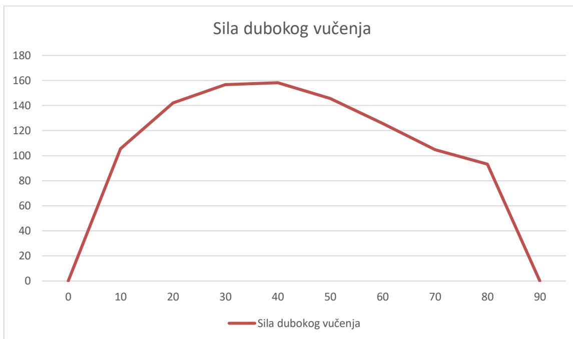
Slika 39. Grafički prikaz prosječne sile dubokog vučenja s obzirom na hod alata
