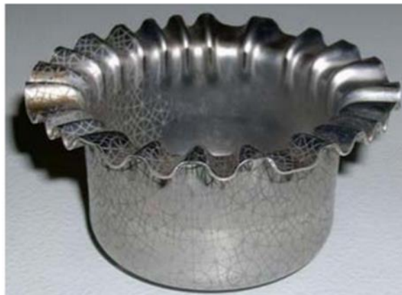
Slika 30. Stvaranje nabora na rubovima posude podvrgnute postupku dubokog vučenja [12]
