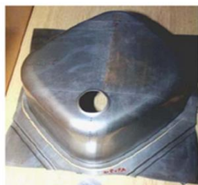
Slika 13. Kutijasti proizvodi dobiveni postupkom dubokog vučenja [12]
