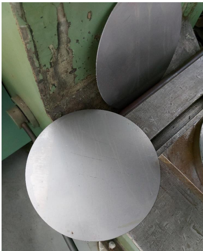
Slika 35. Rondela za eksperimentalni postupak dubokog vučenja
