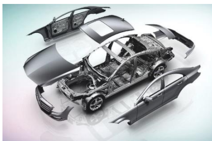
Slika 14. Proizvodi dobiveni postupkom dubokog vučenja: Automobilaska karoserija [14]
