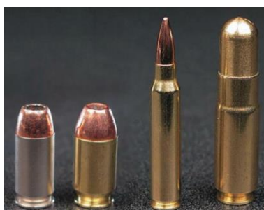
Slika 16. Proizvodi dobiveni postupkom dubokog vučenja: Čahura metka [16]
