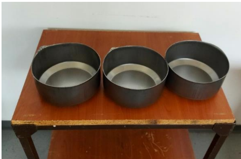
Slika 36. Proizvod nakon prve faze dubokog vučenja
