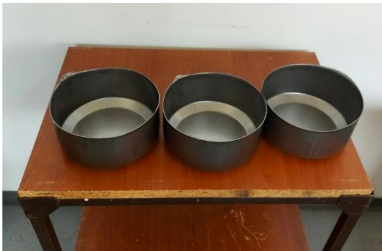
Slika 36. Proizvod nakon prve faze dubokog vučenja
