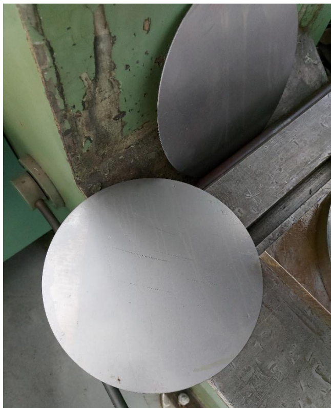
Slika 35. Rondela za eksperimentalni postupak dubokog vučenja
