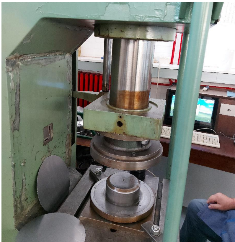
Slika 34. Alat hidrauličke preše za duboko vučenje
