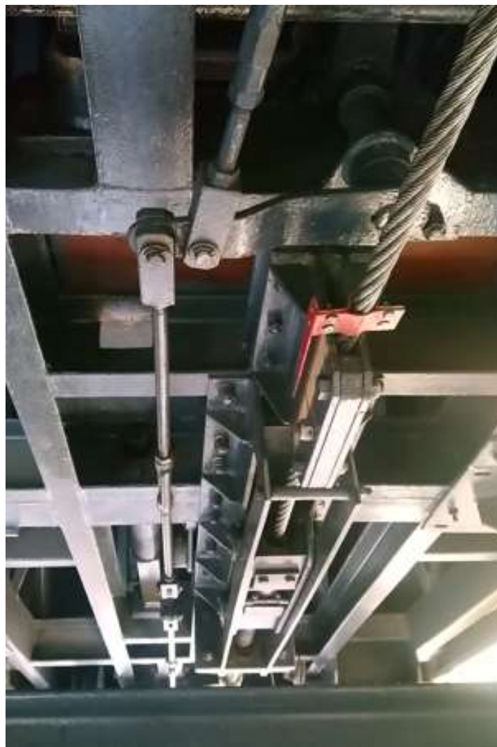
Slika 19 Prihvat užeta na plivajući blok - 25.10.2021.
