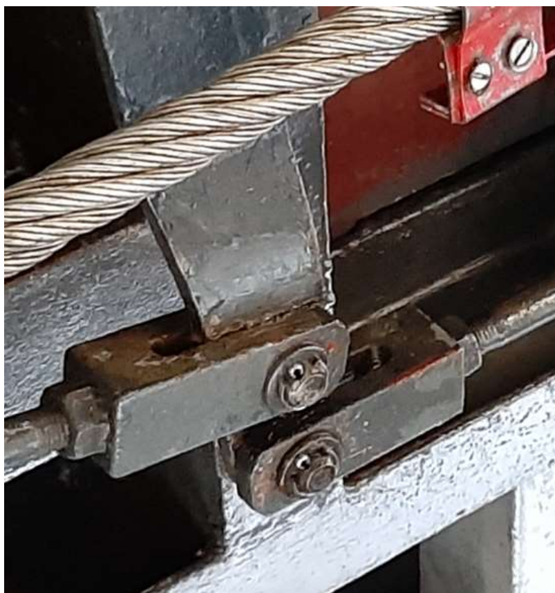
Slika 34 Spoj ušica za polugu zubne letve - slika sa servisa 25.10.2021.
