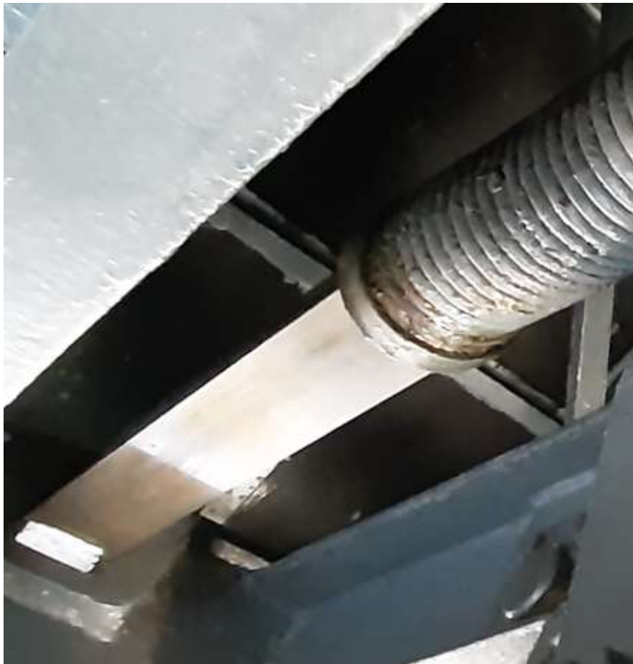
Slika 37 Opruga zubne letve - slika sa servisa 25.10.2021.
