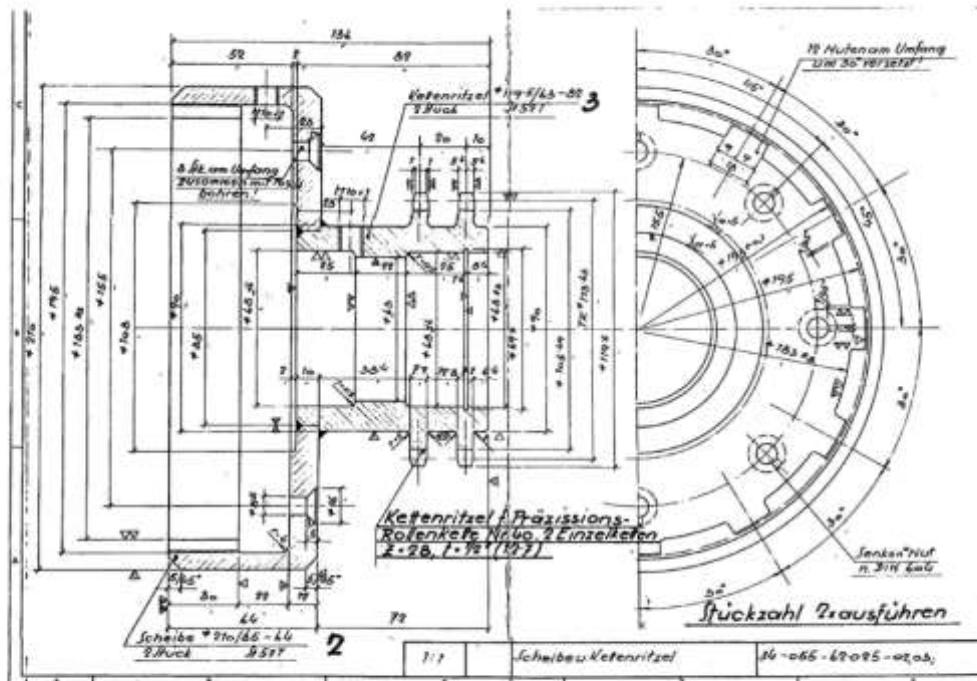
Slika 15 Sklop pogonskog lančanika vanjskog vratila
