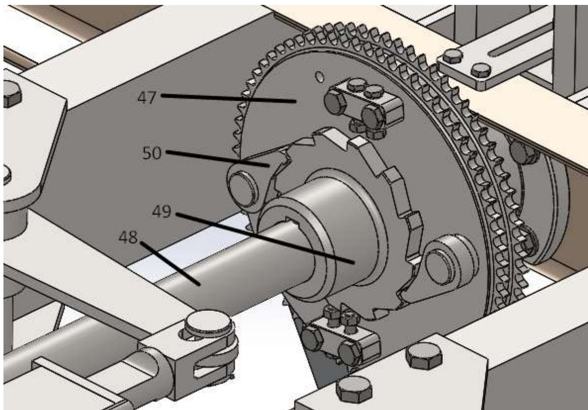
Slika 52 Komponente kočionog vratila i gonjenog lančanika
