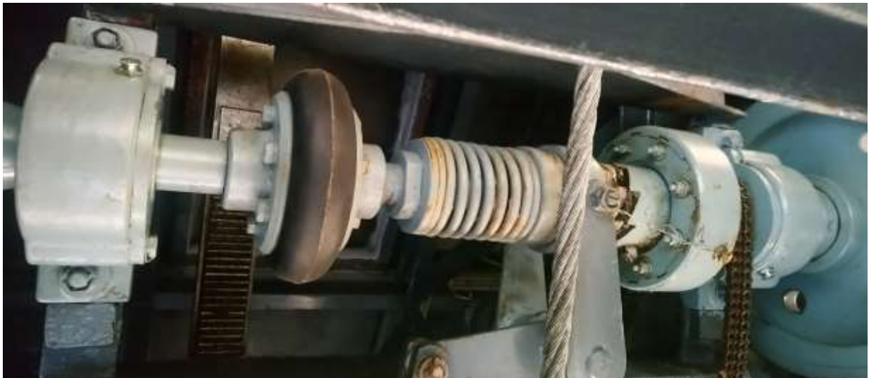
Slika 18 Sklop vanjskog i unutarnjeg vratila - 25.10.2021.
