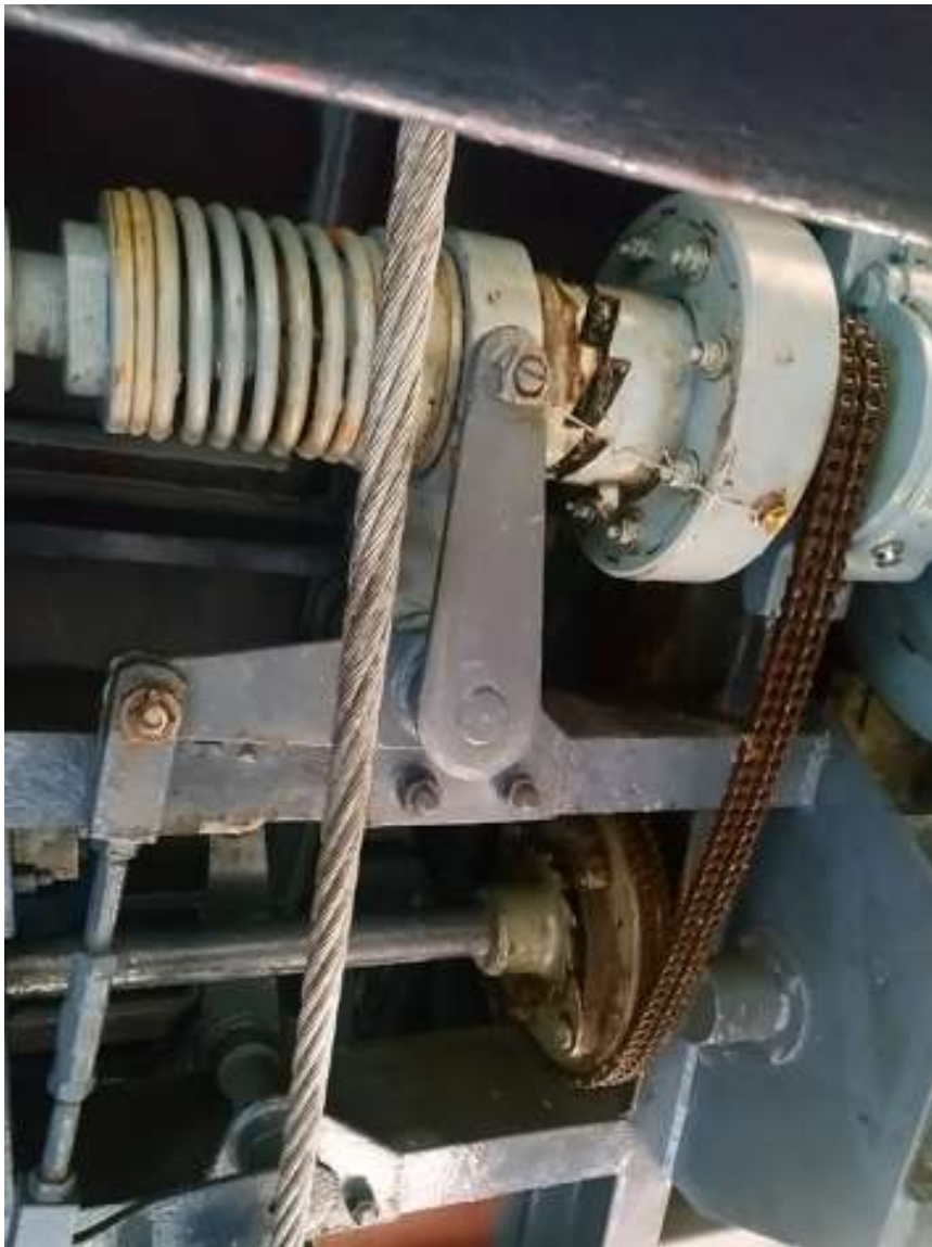
Slika 17 Kandžasta spojka i lanac - slika sa servisa 25.10.2021.
