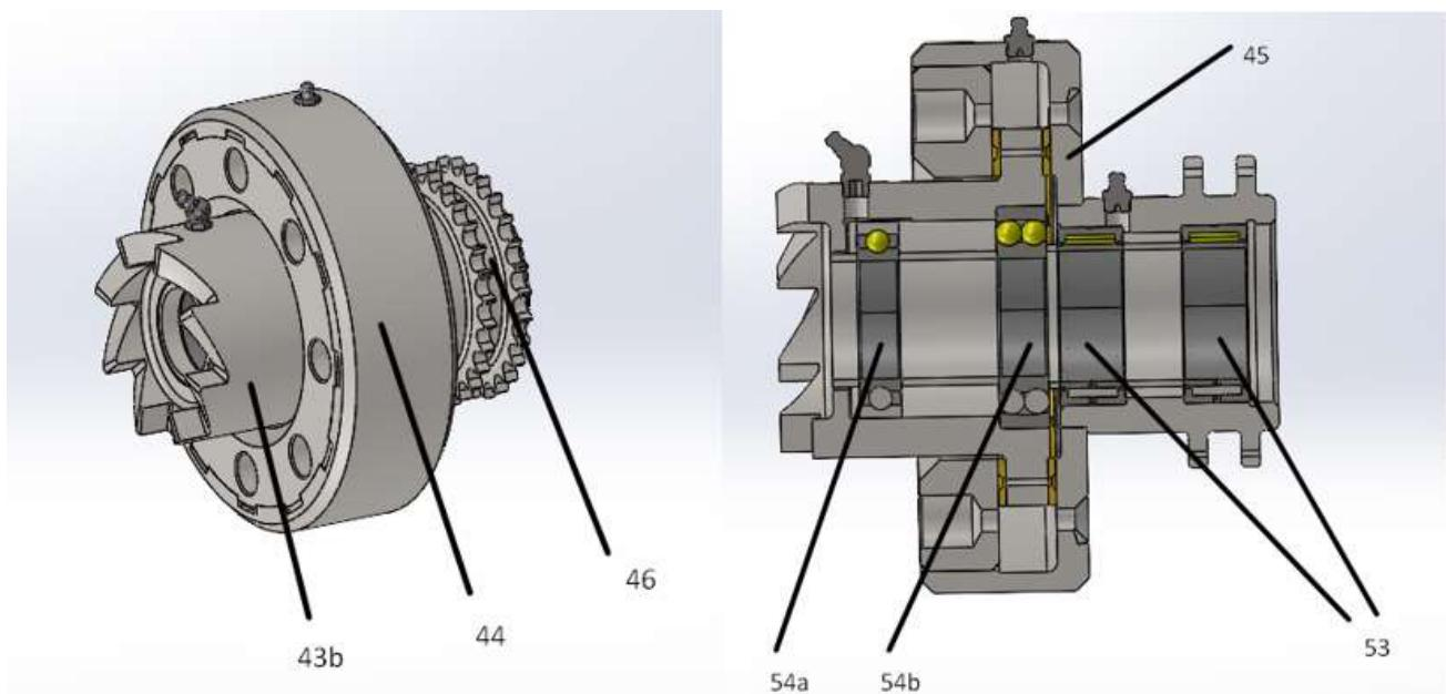
Slika 50 Sklop kandžaste spojke i pogonskog lančanika
