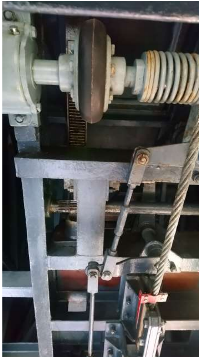
Slika 16 Periflex elastična spojka - slika sa servisa 25.10.2021.
