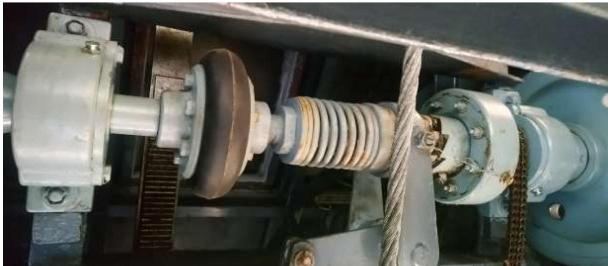
Slika 18 Sklop vanjskog i unutarnjeg vratila - 25.10.2021.
