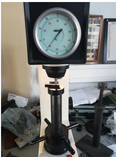
Slika 23. Rockwellov tvrdomjer primijenjen za ispitivanje adhezivnosti prevlake
