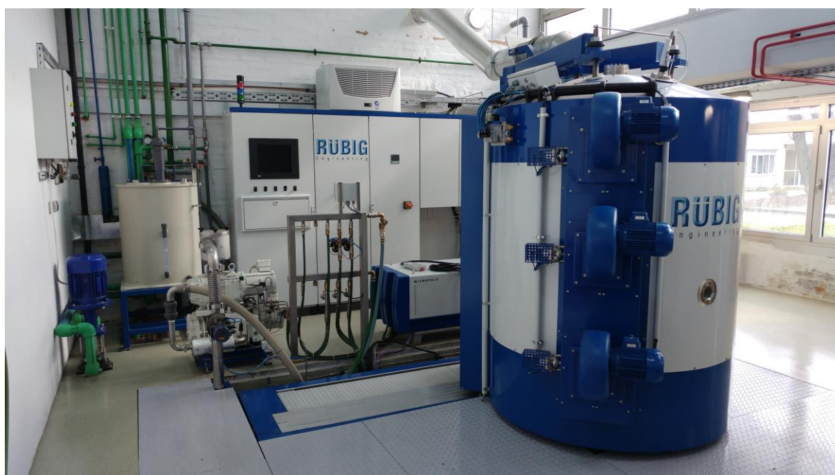
Slika 14. PACVD postrojenje instalirano na FSB-u [12]
