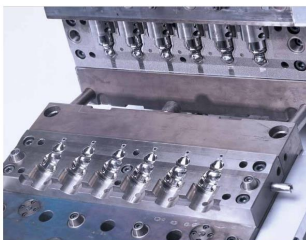
Slika 6. Primjer alata za preradu polimera izrađenog od čelika K490 MC [6]
