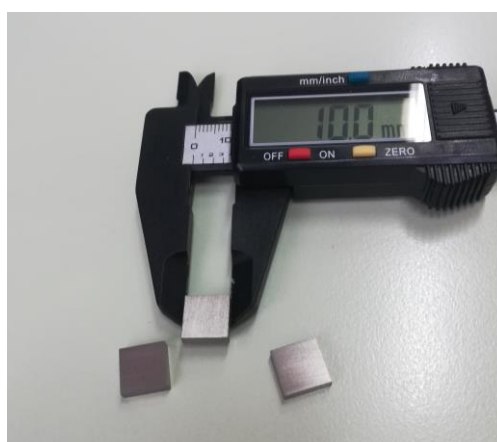
Slika 26. Izgled uzoraka za nitiranje i vanjska dimenzija
