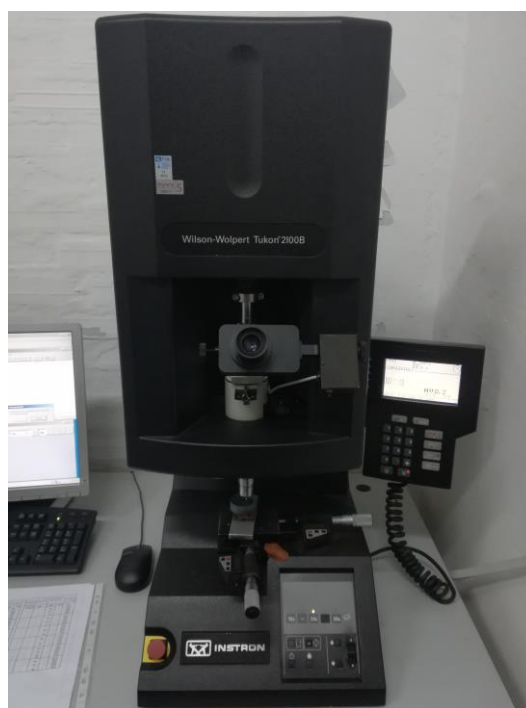
Slika 19. Tvrdomjer INSTRON Wilson-Wolpert Tukon 2100B
