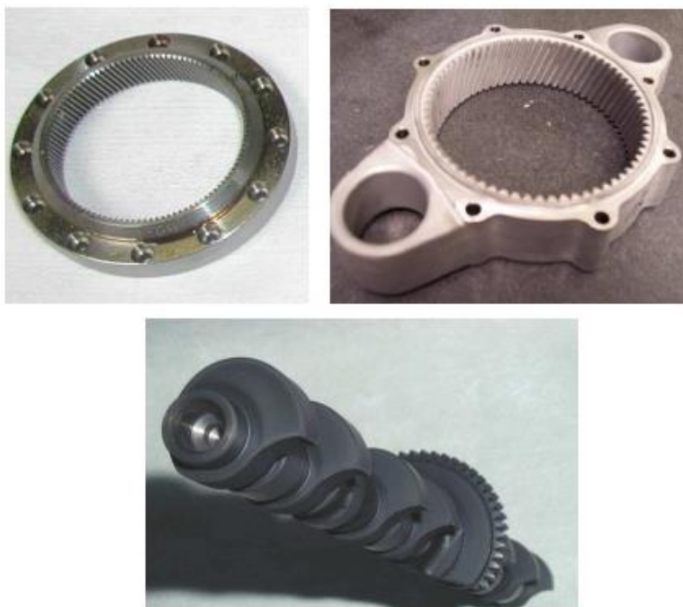
Slika 11. Primjeri dijelova pogodnih za nitriranje u plazmi [11]
