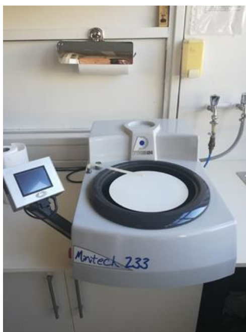
Slika 53. Uređaj za poliranje uzoraka
