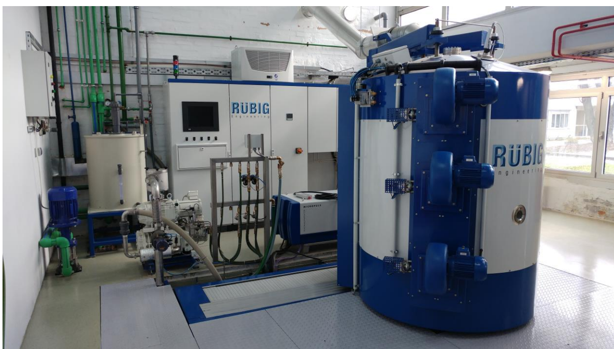
Slika 14. PACVD postrojenje instalirano na FSB-u [12]
