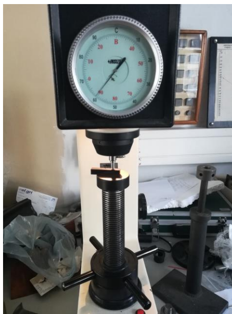
Slika 23. Rockwellov tvrdomjer primijenjen za ispitivanje adhezivnosti prevlake
