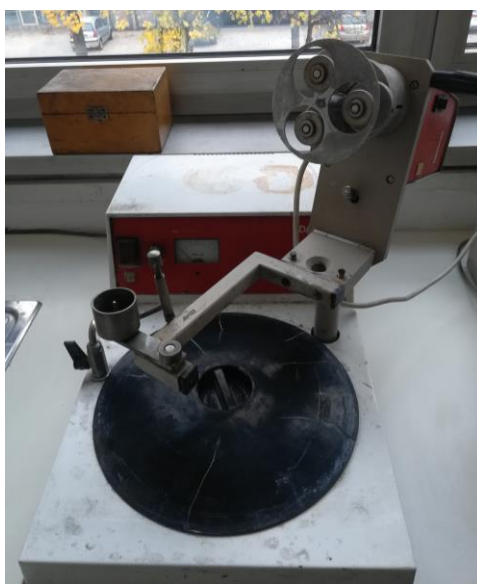
Slika 52. Uređaj za brušenje uzoraka
