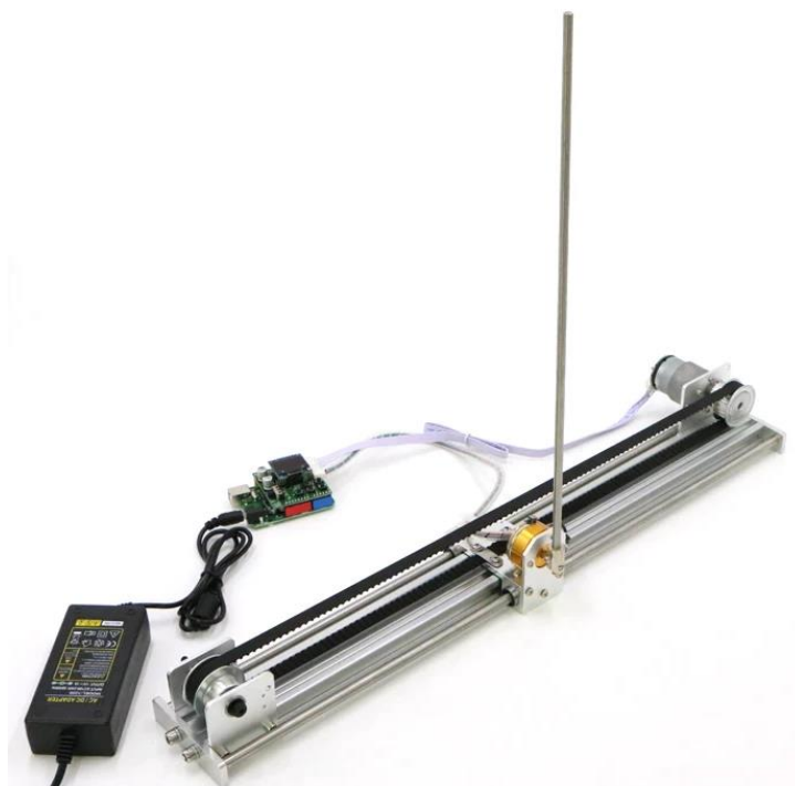
Slika 3. Inverzno njihalo regulirano električnim aktuatom i remenskim prijenosom[5]
