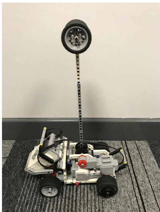
Slika 4. Inverzno njihalo na kolicima s kotačima [6]
