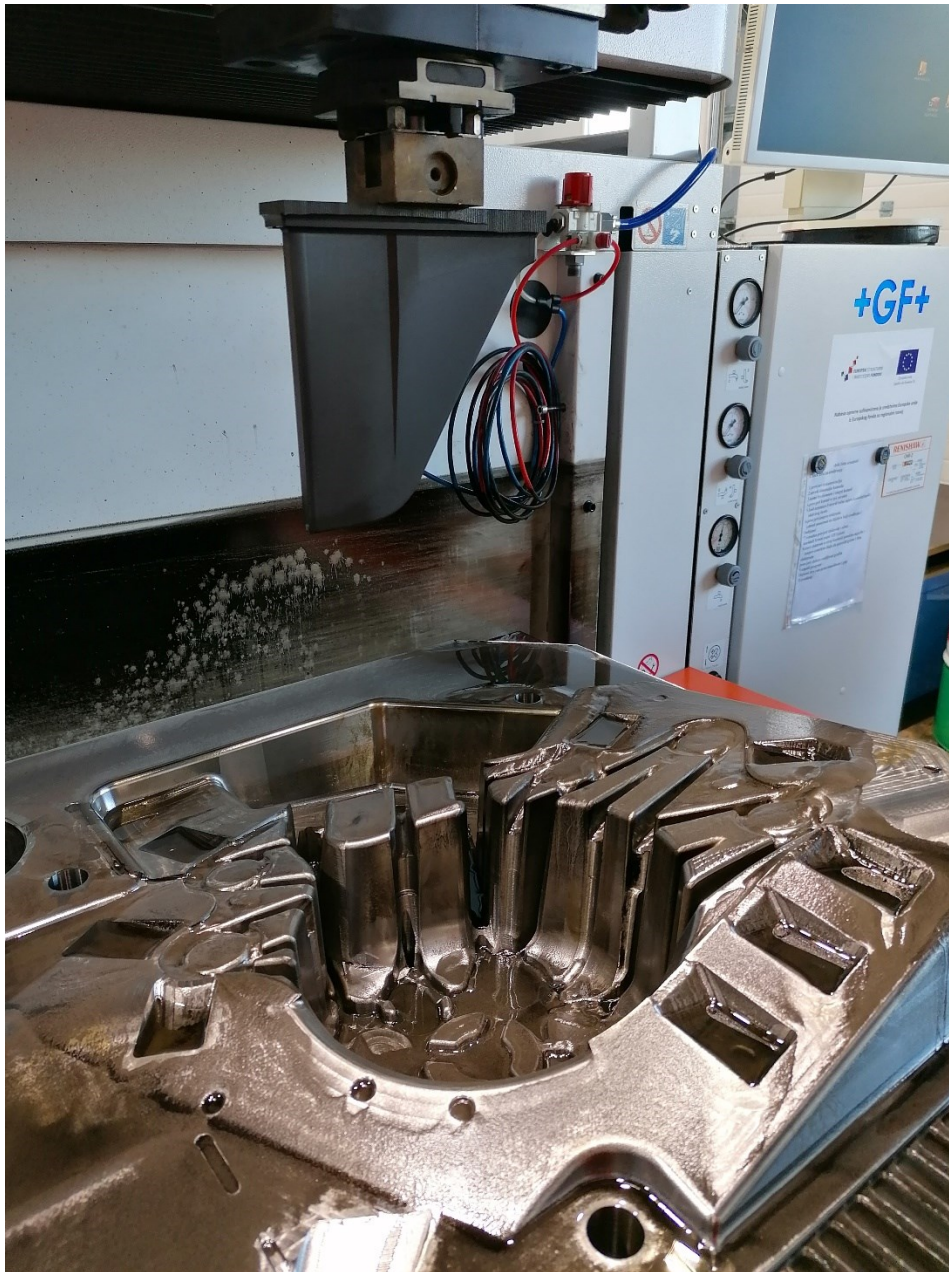
Slika 24 Primjer EDM obrade utora kod izrade kalupa
