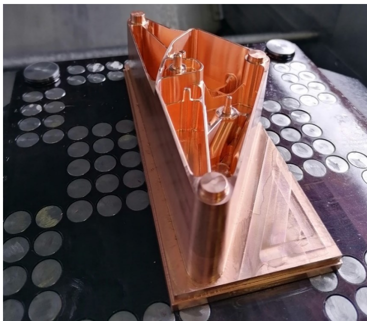
Slika 50 Primjer složene bakrene elektrode
