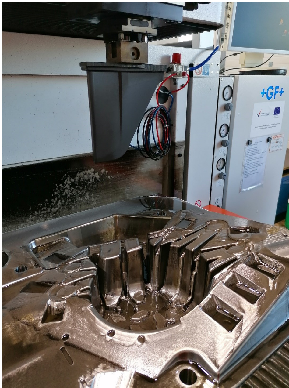
Slika 24 Primjer EDM obrade utora kod izrade kalupa
