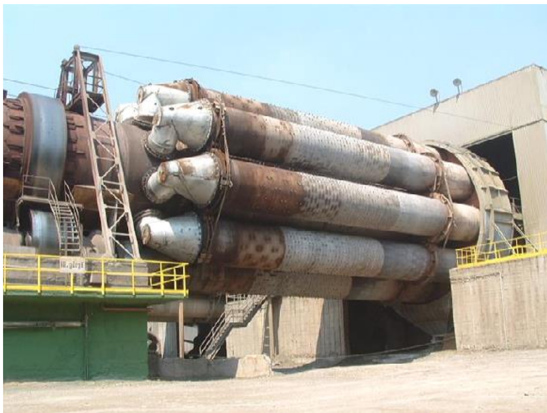
Slika 7. Planetarni hladnjak klinkera [1]
