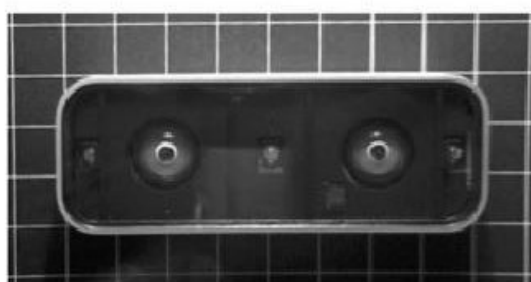
Slika 26. Konstrukcija uređaja Leap Motion Controller [33]
