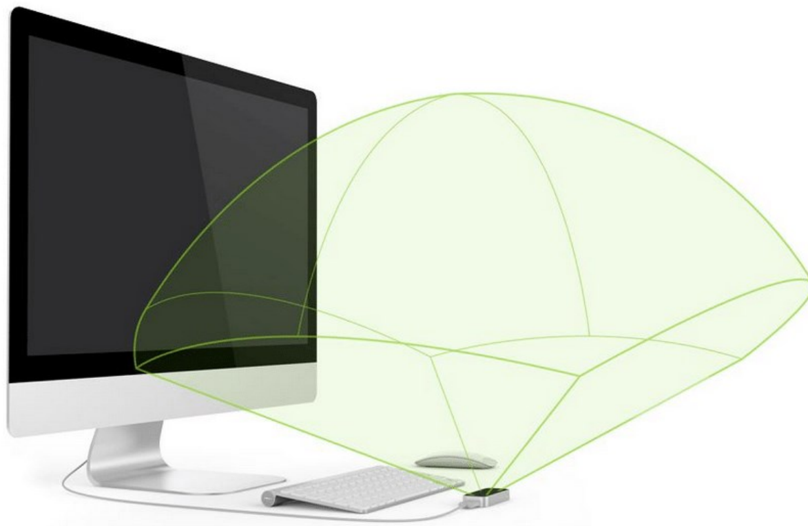
Slika 27. Vidno polje uređaja Leap Motion Controller [34]
