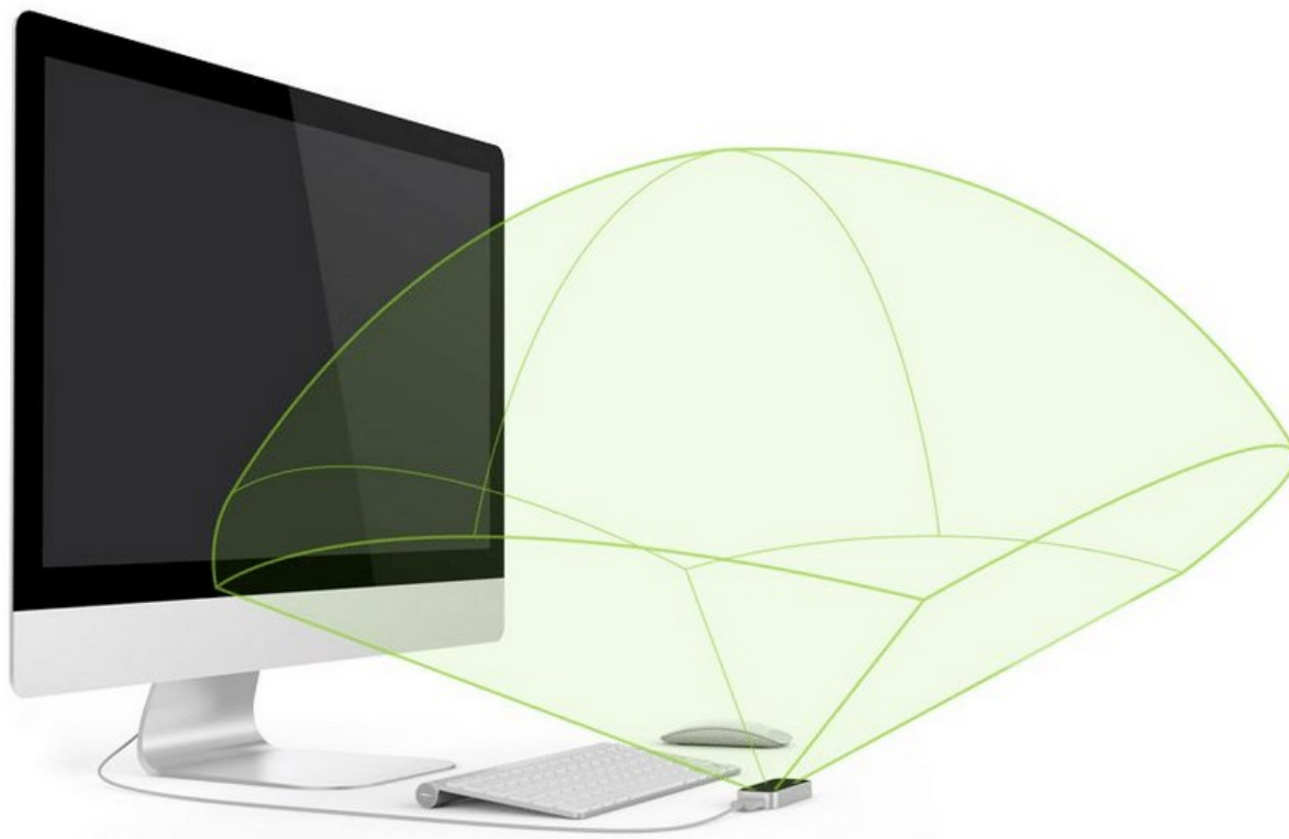
Slika 27. Vidno polje uređaja Leap Motion Controller [34]
